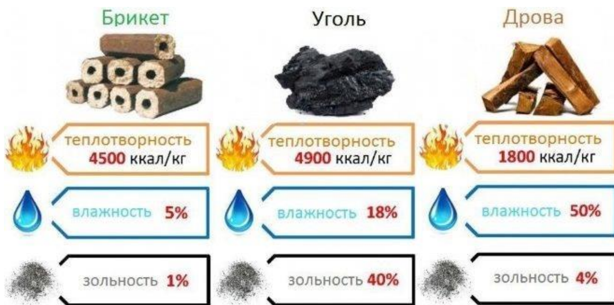
Рисунок 2 – Сравнение основных параметров различных типов твердого топлива
