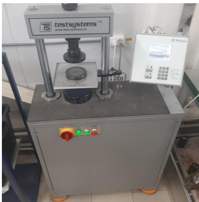
Рисунок 13 – Гидравлический пресс для испытания образцов на прочность
