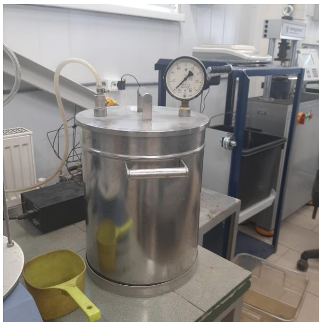
Рисунок 12 – Вакуум-прибор для водонасыщения образцов
