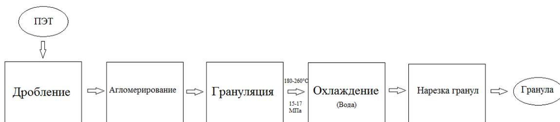
Рисунок 15 – Технологический процесс переработки отходов полиэтилена
