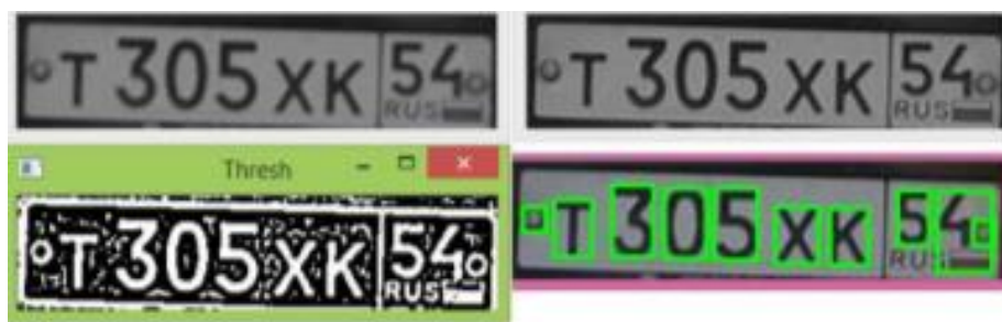
Рисунок 1.9 – Пример работы алгоритма Виолы-Джонса для распознавания автомобильных номеров
