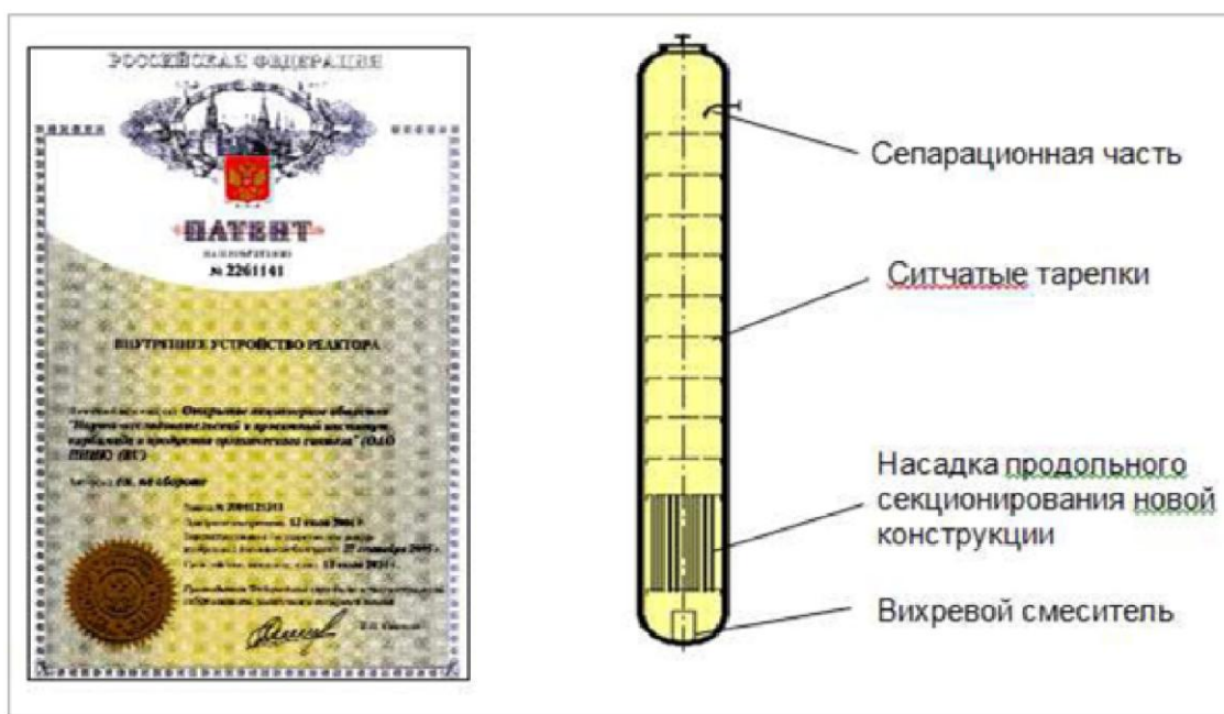
Рисунок 5 - Усовершенствованный узел синтеза карбамида
