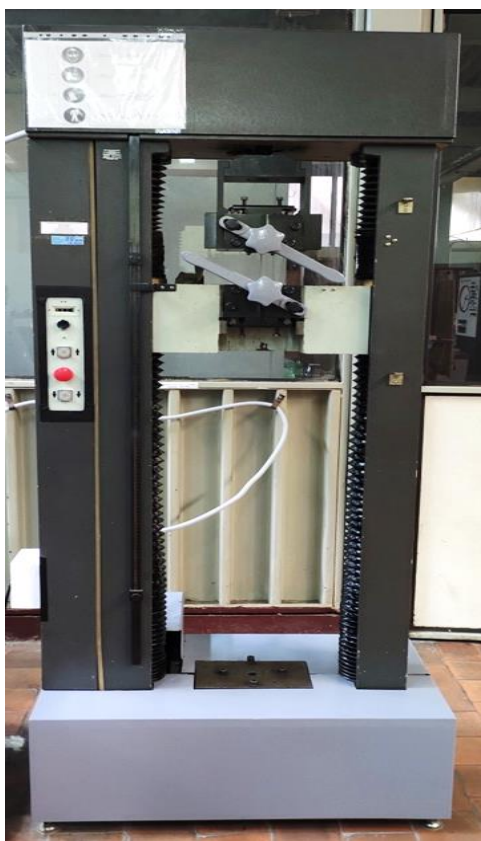
Рисунок 13 – Испытательная машина «FPZ 100/1»
