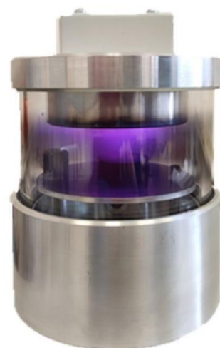
Рисунок 18 – Напыление поверхности образца
