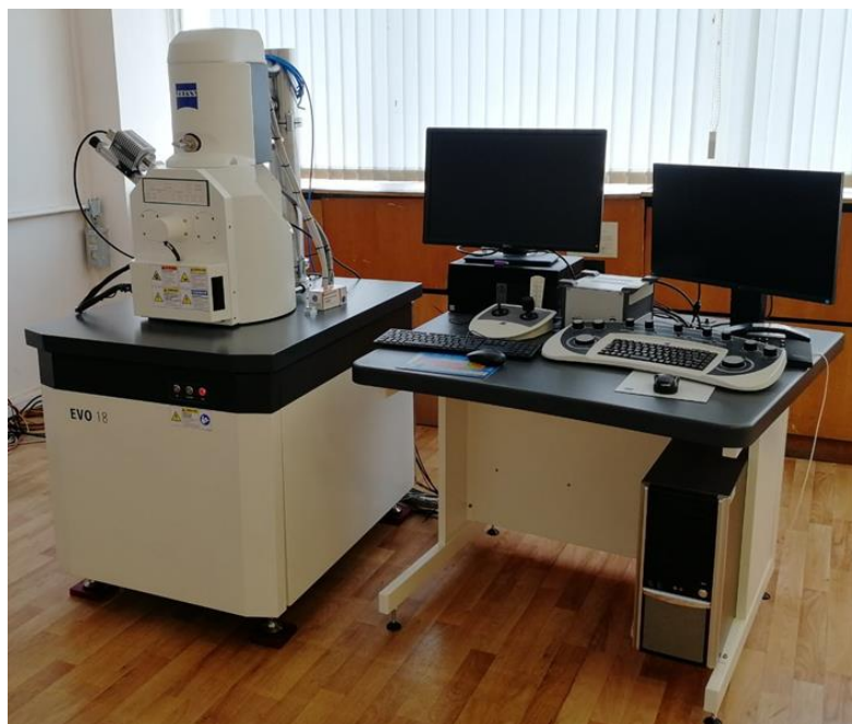
Рисунок 16 – Сканирующий электронный микроскоп Zeiss SEM «EVO 18»
