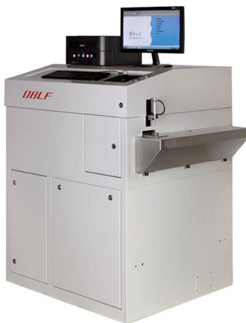
Рисунок 19 – Спектрометр OBLF QSN750-11
