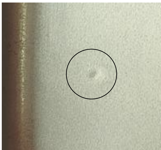
Рисунок 41 – Внешний вид фрагмента с утонением на заготовке после вытяжки
