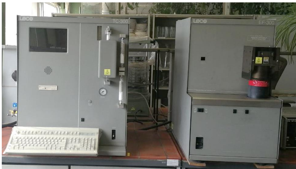
Рисунок 20 – Анализатор азота и кислорода LECO TC-300
