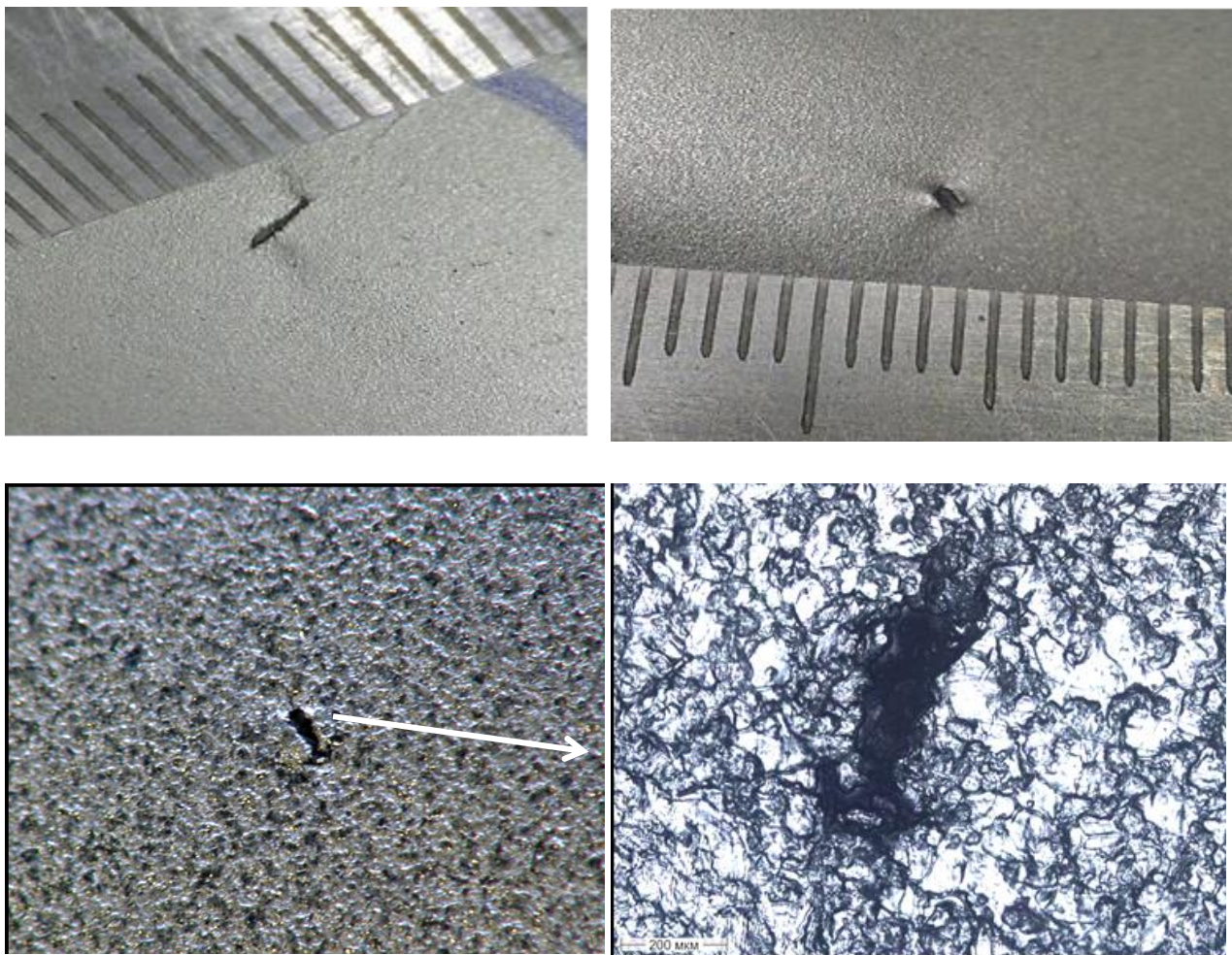
Рисунок 3 – Внешний вид фрагментов штампованных горячеоценкованных деталей с разрывами (надрывами) стали 006/IF BOCB MCO
