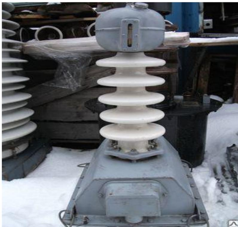
Рисунок 4 – Трансформатор тока ТФМ – 35 кВ
