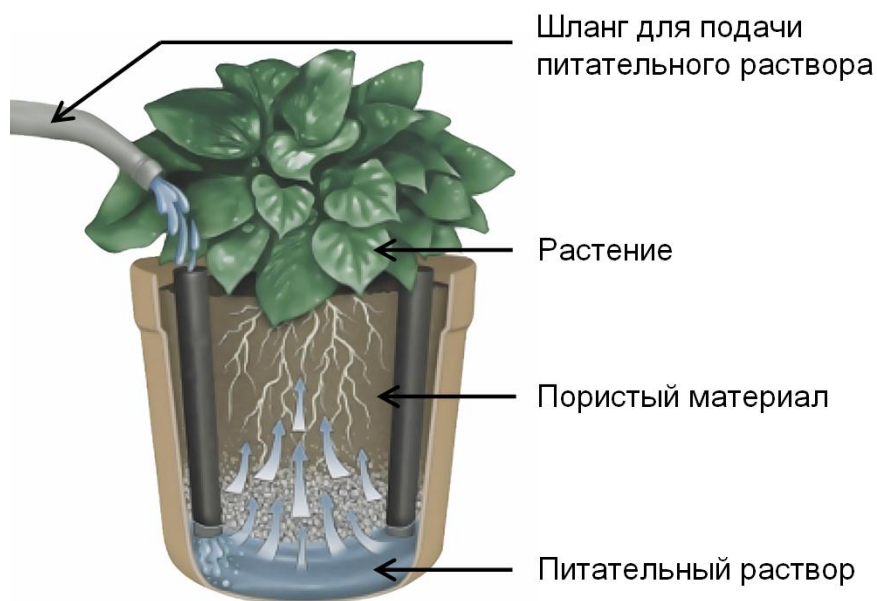
Рисунок 1 – Простейшая фитильная гидропонная система
