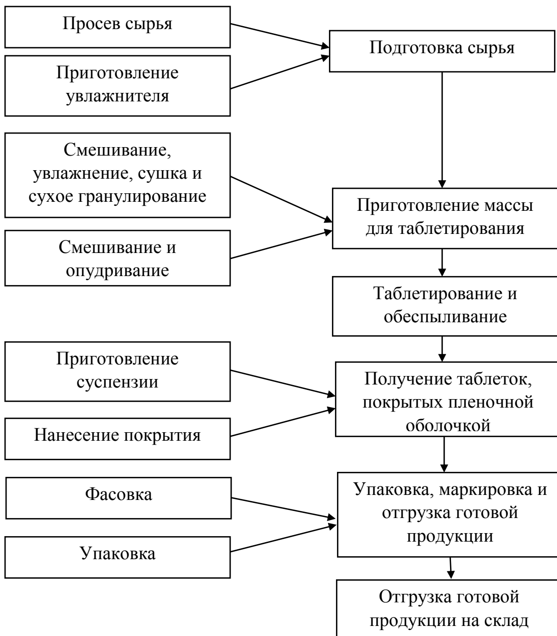
Рисунок 3 - Технологическая схема производства препарата «Венарус®» таблетки, покрытые пленочной оболочкой, 100 мг + 900 мг»
