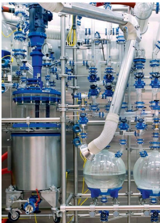
Рисунок 92 – Опытно-промышленная установка chemReactor CR компании BuchiGlasUster
