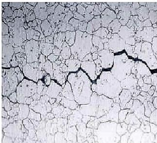
Рисунок 6 - Трещина по границам зерен в трубе [3]
