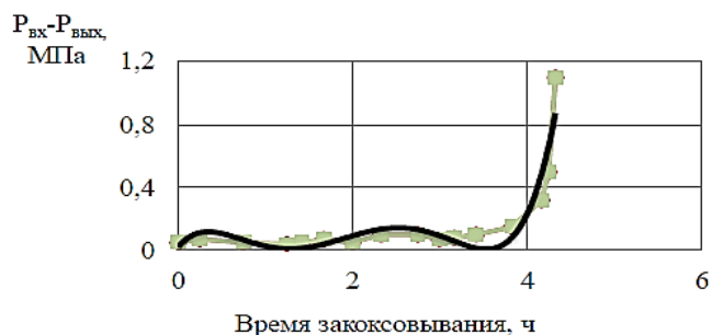
Рисунок 4 - Динамика закоксовывания змеевика [21]
