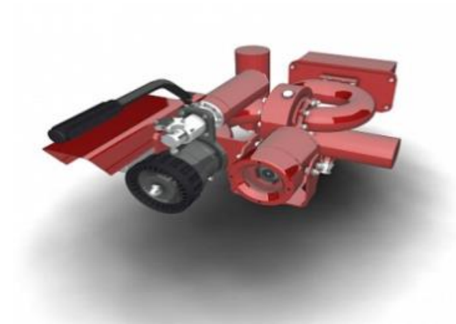
Рисунок 7 – Универсальная радиоуправляемая машина для борьбы с низовыми пожарами, 3D-модель
