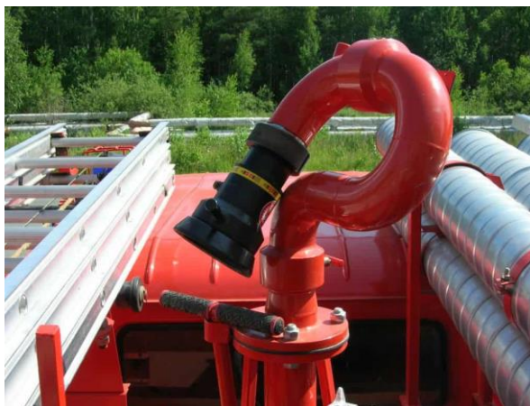
Рисунок 18 – Лафетный стационарный ствол ЛС-С-40УВ
