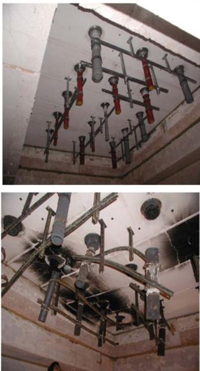
Рисунок 23 – Результаты до проведения и после проведения испытаний противопожарной манжеты согласно патенту 2731120
