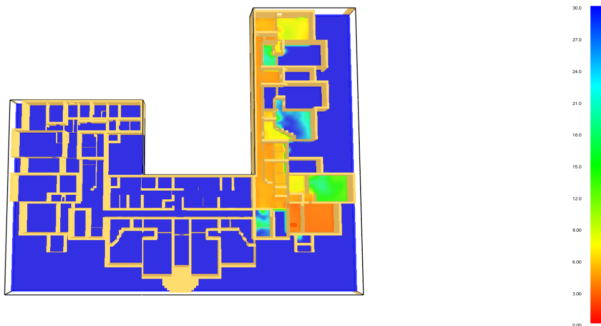
Рисунок В5 – Поле распространения ОФП по потере видимости на высоте 1.7 м от уровня пола 1-го этажа в момент времени, равный 600 с от начала возгорания
