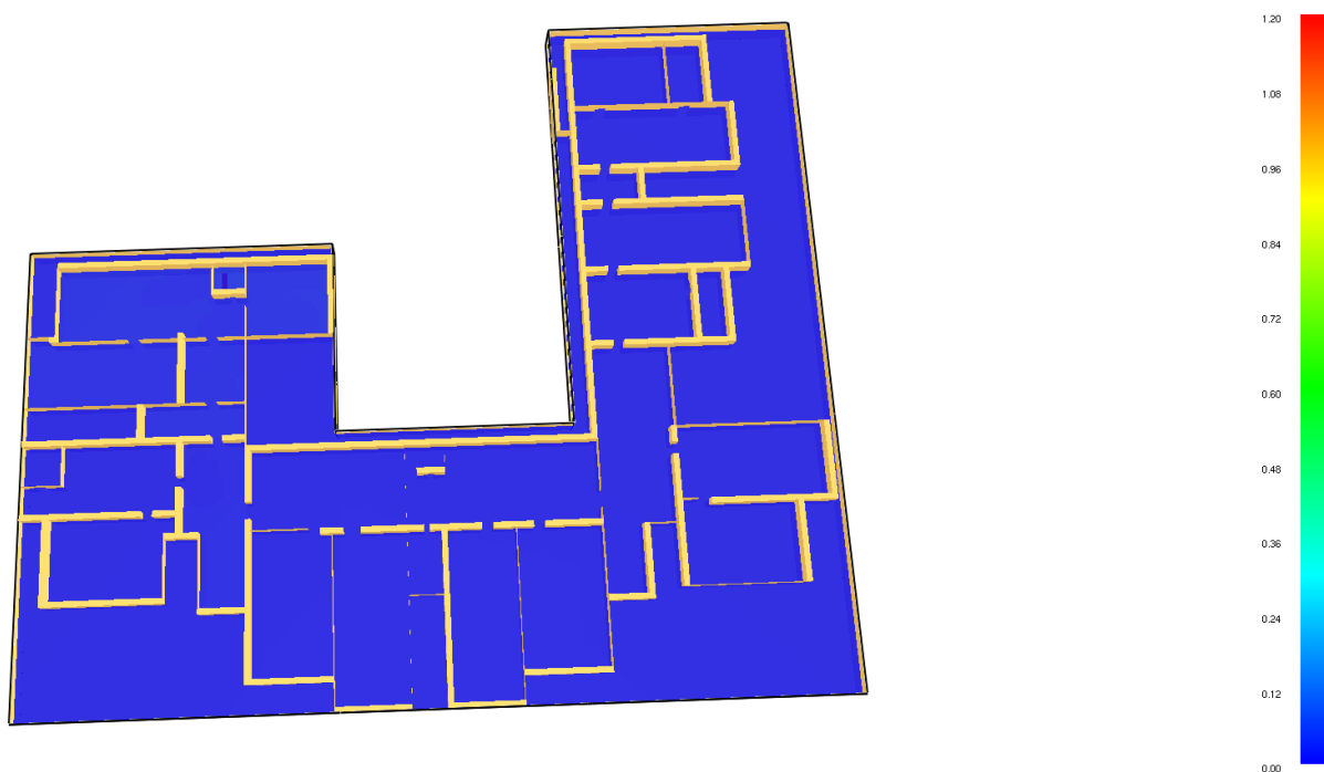
Рисунок Г8 – Поле распространения ОФП по содержанию CO_2 на высоте 1.7 м от уровня пола в момент времени, равный 300 с от начала возгорания
