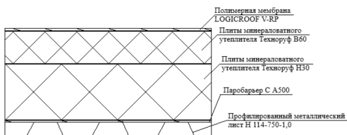
Рисунок 1.2 – Конструкция кровли
