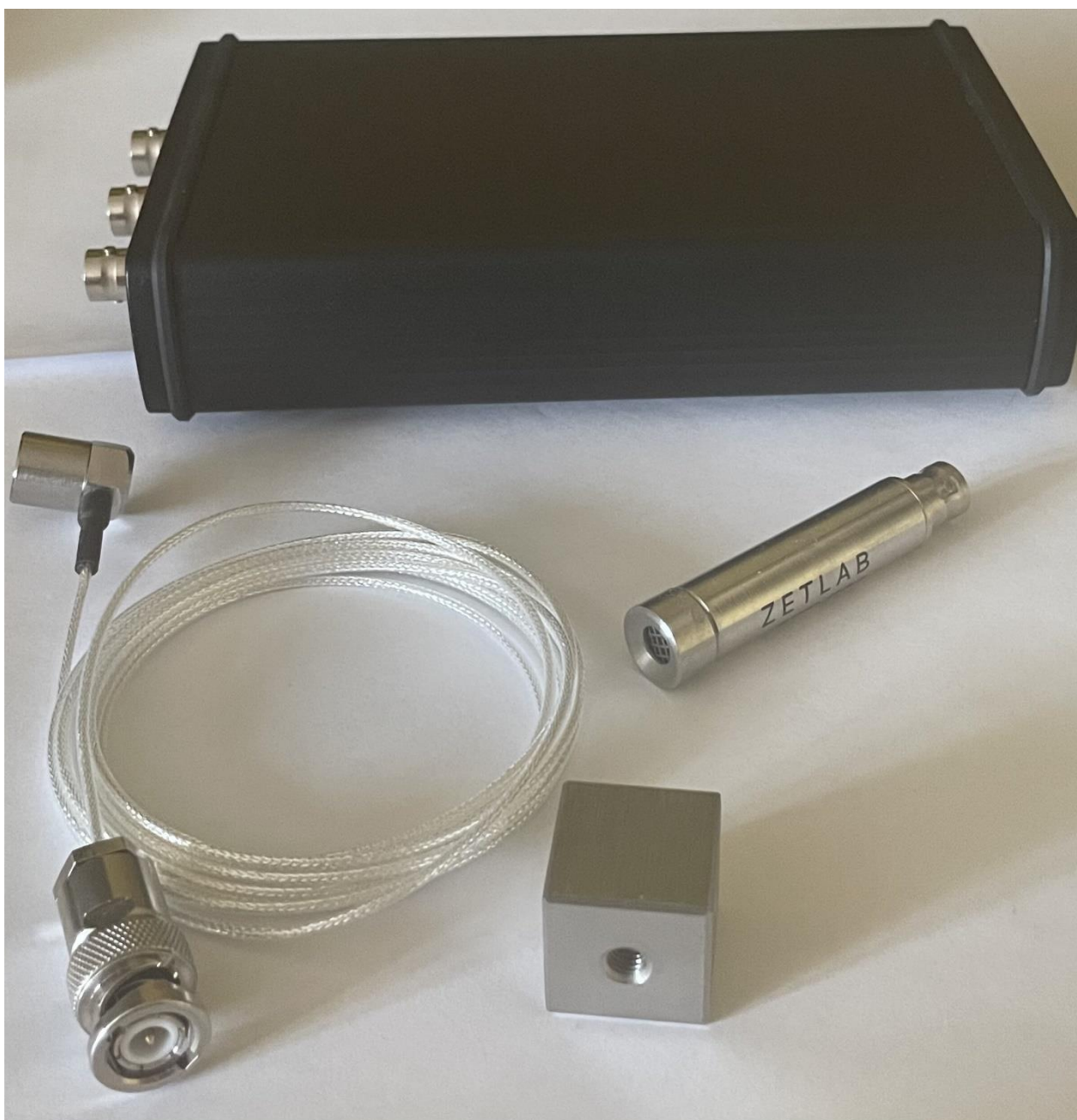
Рисунок 11 – Датчики и плата сбора данных ZETLAB. Внизу слева направо: акселерометр BC 111, магнитный кубик AM51 для крепления акселерометра, микрофон ZET 501.
