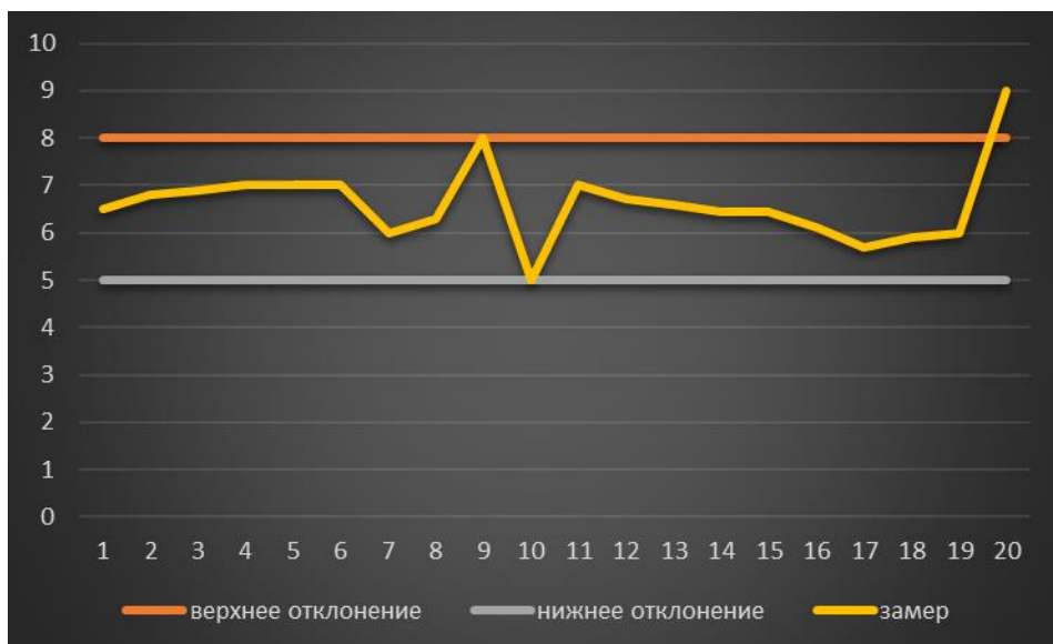
Рисунок 58 – График средних значений толщин второго слоя базисной эмали 238 цвета.
