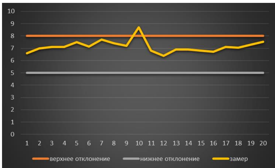
Рисунок 48 – График средних значений толщин второго слоя базисной эмали 624 цвета.
