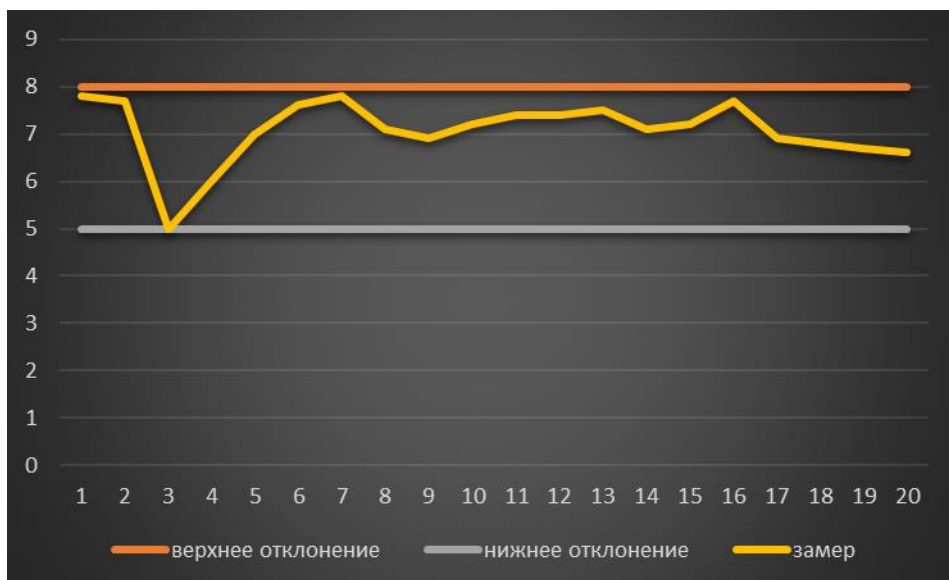
Рисунок 60 – График средних значений толщин второго слоя базисной эмали 136 цвета.
