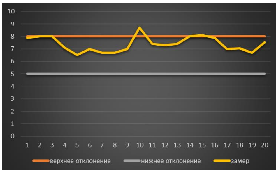
Рисунок 56 – График средних значений толщин второго слоя базисной эмали 242 цвета.
