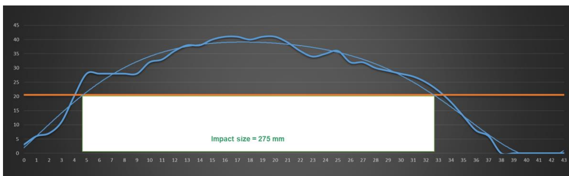
Рисунок 17 – полезный отпечаток окрасочного факела первого робота нанесения базисной эмали 676.
