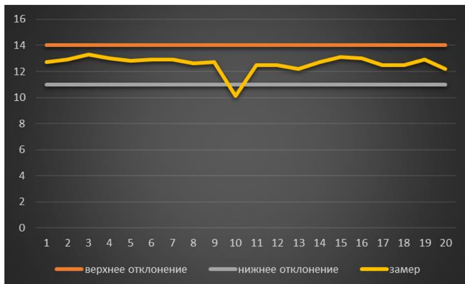
Рисунок 46 – График средних значений толщин второго слоя базисной эмали 221 цвета.
