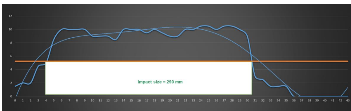
Рисунок 21 – полезный отпечаток окрасочного факела первого робота нанесения базисной эмали 250.
