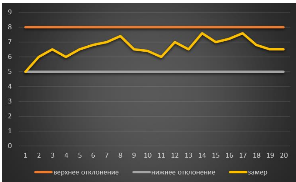
Рисунок 52 – График средних значений толщин второго слоя базисной эмали 498 цвета.
