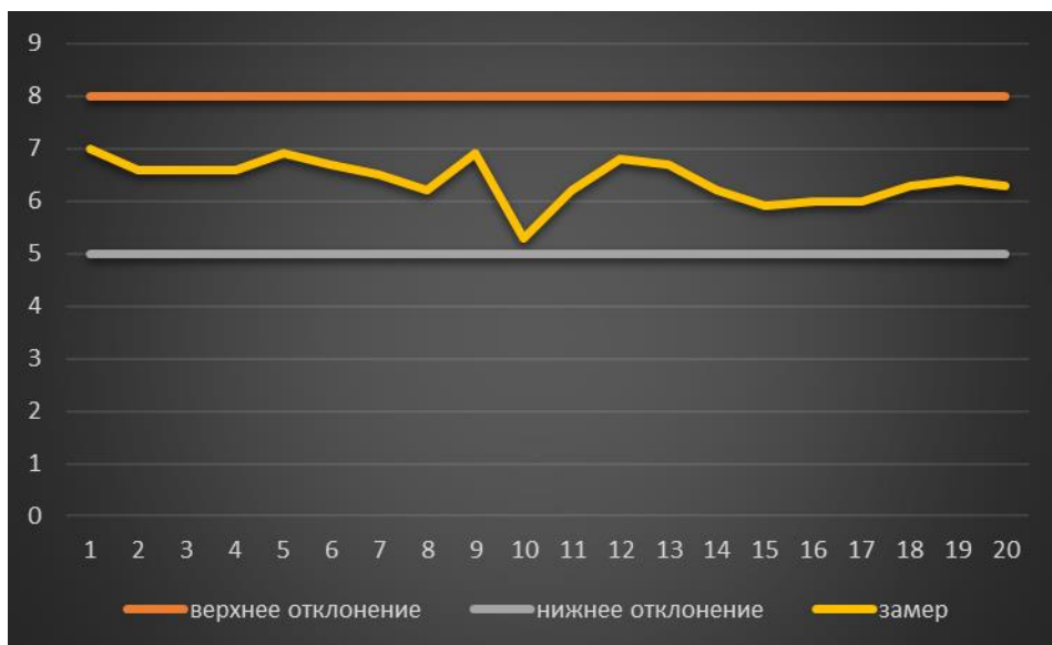
Рисунок 50 – График средних значений толщин второго слоя базисной эмали 676 цвета.
