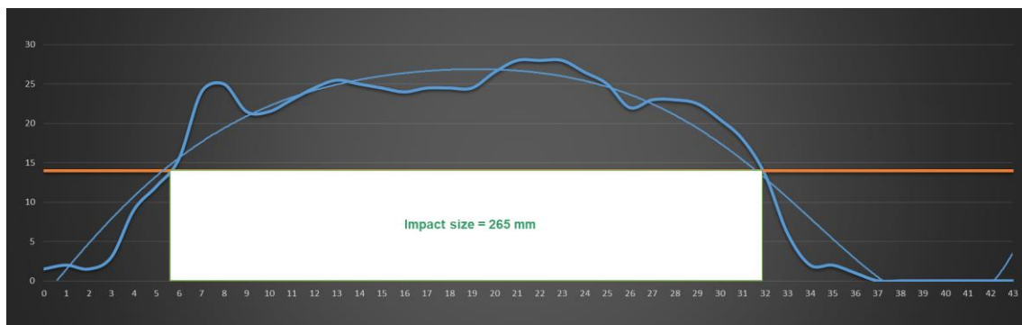
Рисунок 11 – полезный отпечаток окрасочного факела первого робота нанесения лака.
