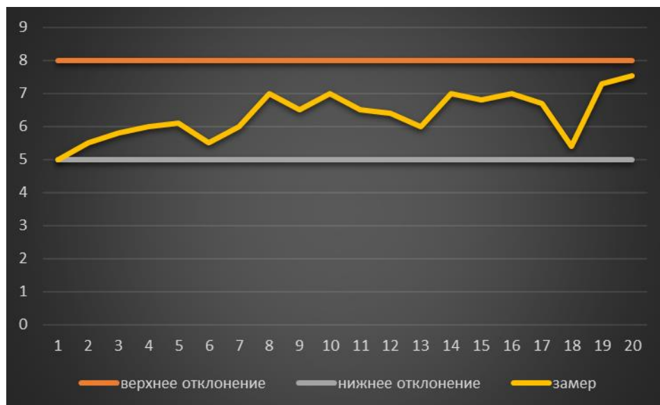
Рисунок 54 – График средних значений толщин второго слоя базисной эмали 250 цвета.
