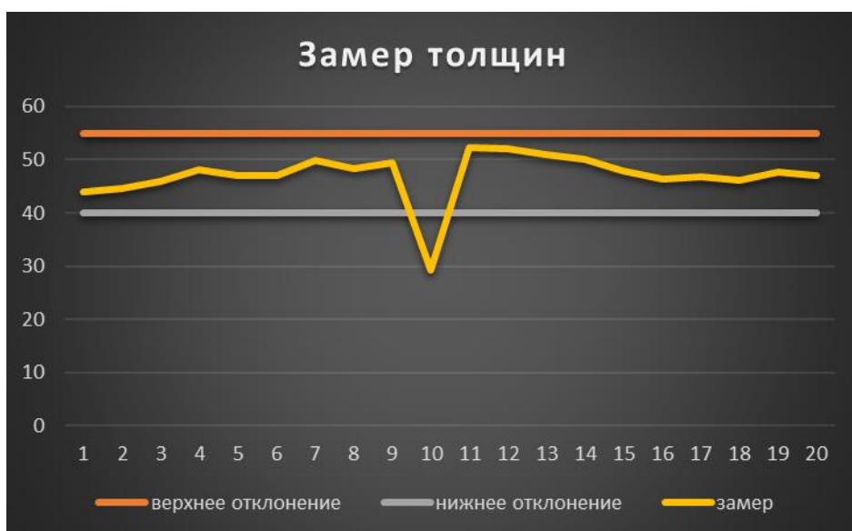
Рисунок 61 – График средних значений толщин акрилового лака.
