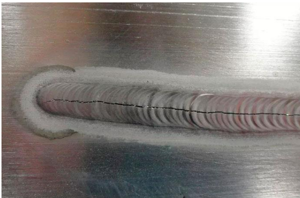
Рисунок 2 – Внешний вид продольной трещины
