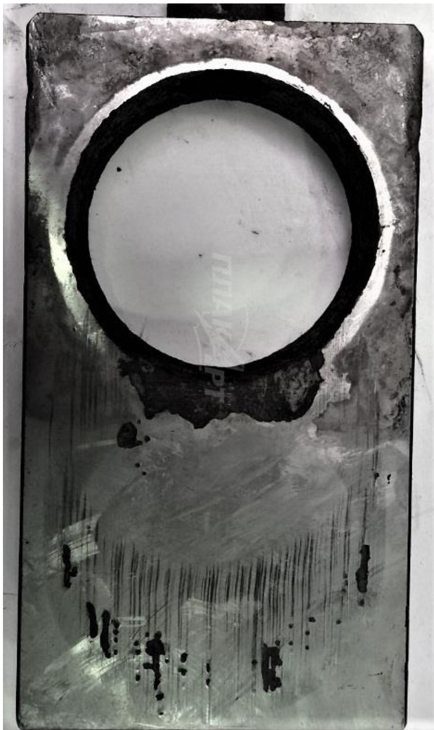
Рисунок 8 – Пример износа шибера задвижки [20]
