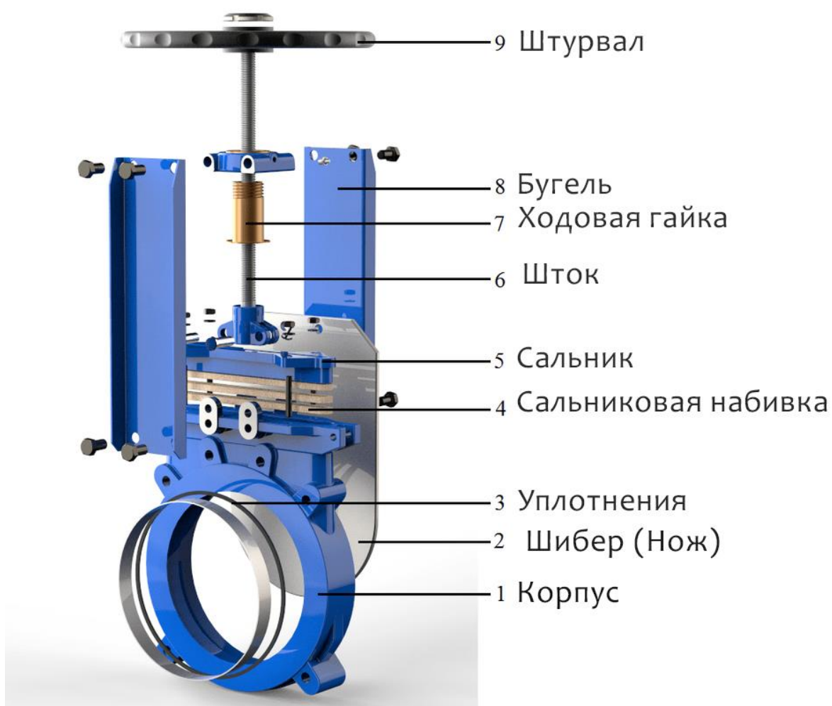
Рисунок 3 – Конструкция шиберной задвижки [27]
