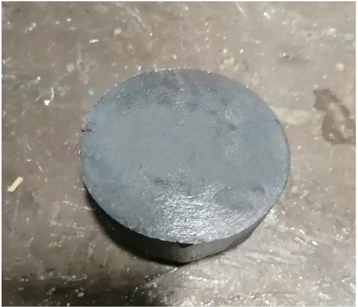
Рисунок 14 – Образец подготовленной заготовки для наплавки
