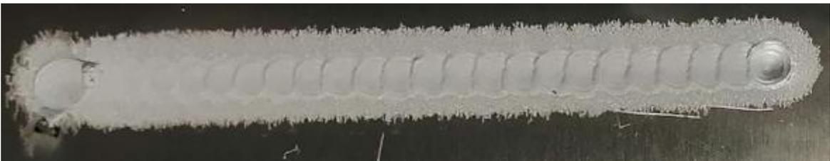
Рисунок 42– Испытания №4 – внешний вид наплавки.  $L_0=4,5\text{мм}$
