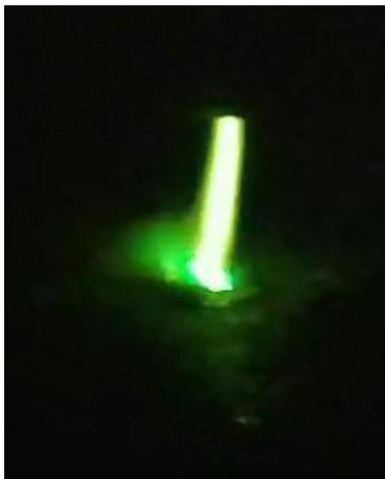
Рисунок 46 – Столб сжатой дуги перед обрывом во время паузы
