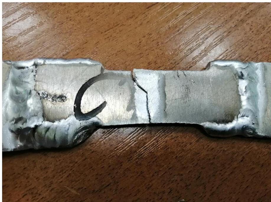
Рисунок 53– Внешний вид образца после разрыва
