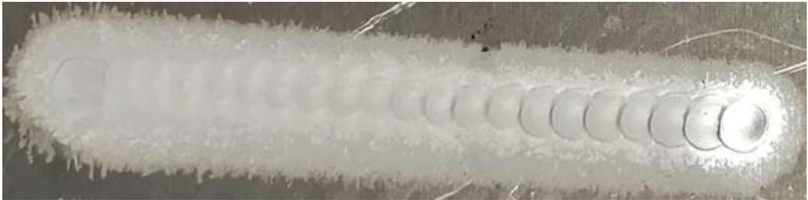
Рисунок 40– Испытания №2 – внешний вид наплавки.  $L_0=2\text{мм}$
