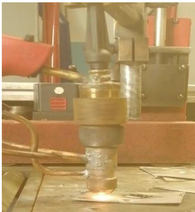
Рисунок 58 Наплавка точек на алюминиевые пластины
