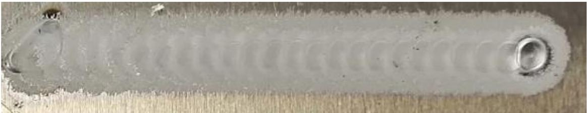
Рисунок 41– Испытания №3 – внешний вид наплавки.  $L_0=3\text{мм}$
