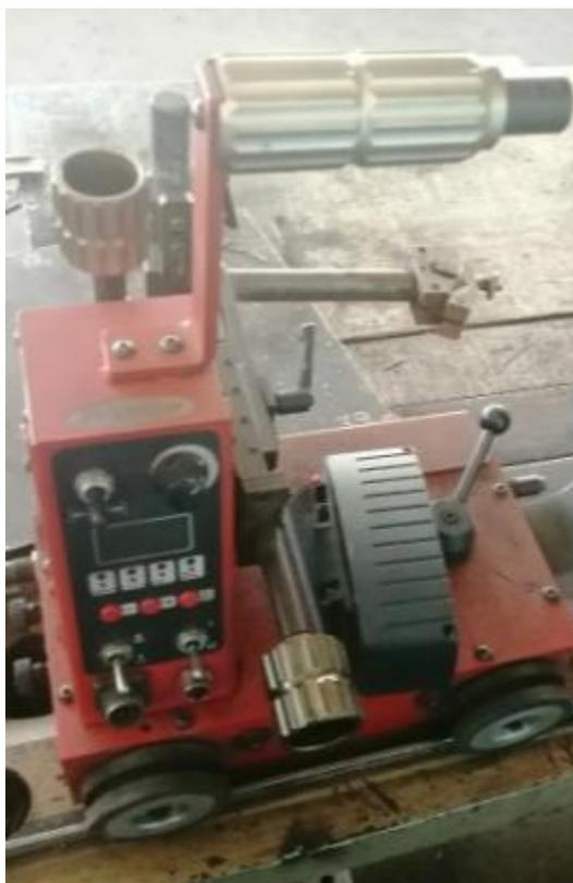
Рисунок 20 – внешний вид сварочного трактора FDV 22 MF
