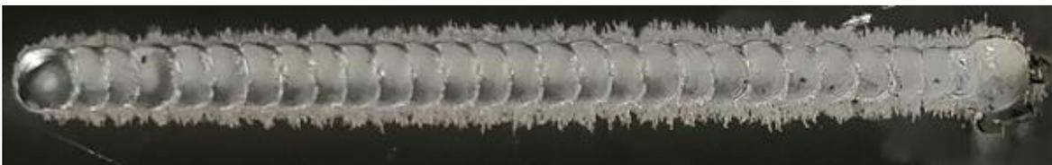
Рисунок 43– Испытания №5 – внешний вид наплавки.  $L_0=6\text{мм}$
