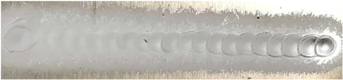
Рисунок 39– Опыт №1 – внешний вид наплавки.  $L_0=1\text{мм}$
