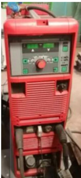
Рисунок 21– Внешний вид источника питания MagicWave 5000 Job
