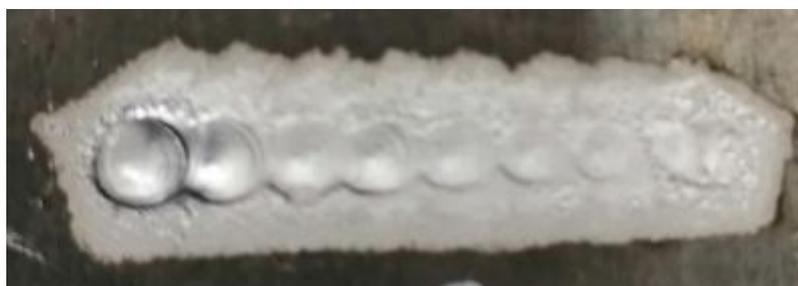
Рисунок 33– Внешний вид наплавки после опыта №1.  $L_0=2\text{мм}$
