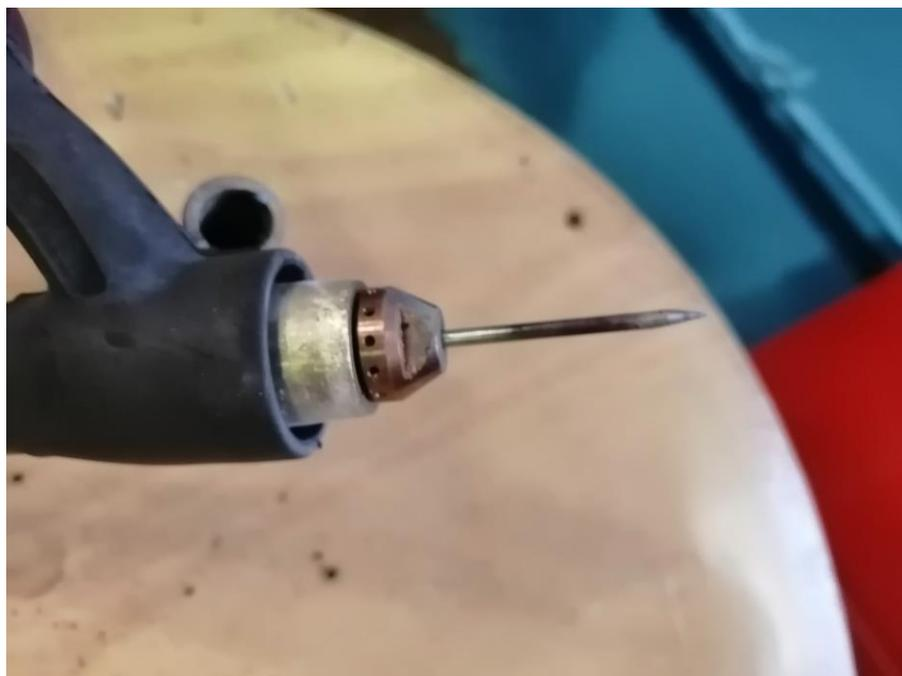
Рисунок 23 – Рабочая часть сварочной горелки без керамического сопла
