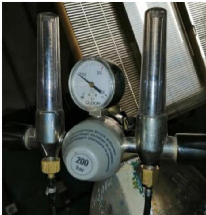
Рисунок 24 – Редуктор газовый двумя ротаметрами
