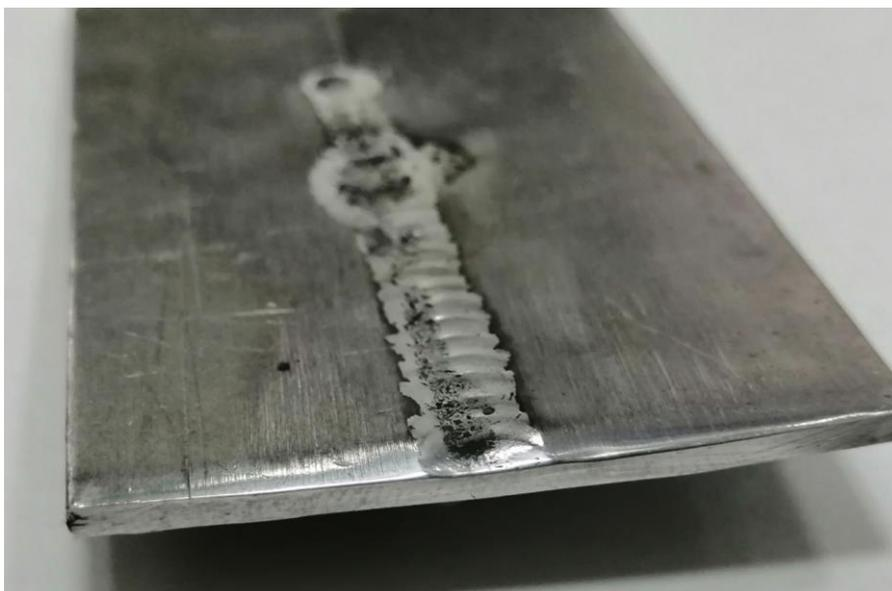
Рисунок 50 – Внешний вид шва после наплавки пульсирующей сжатой дугой
