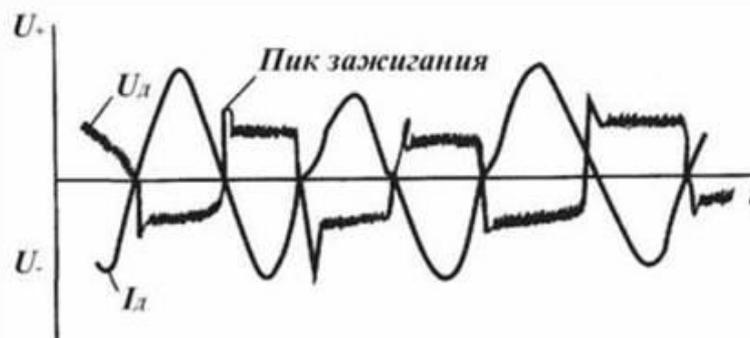
Рисунок 2 – Формы тока и напряжения при горении дуги на переменном токе
