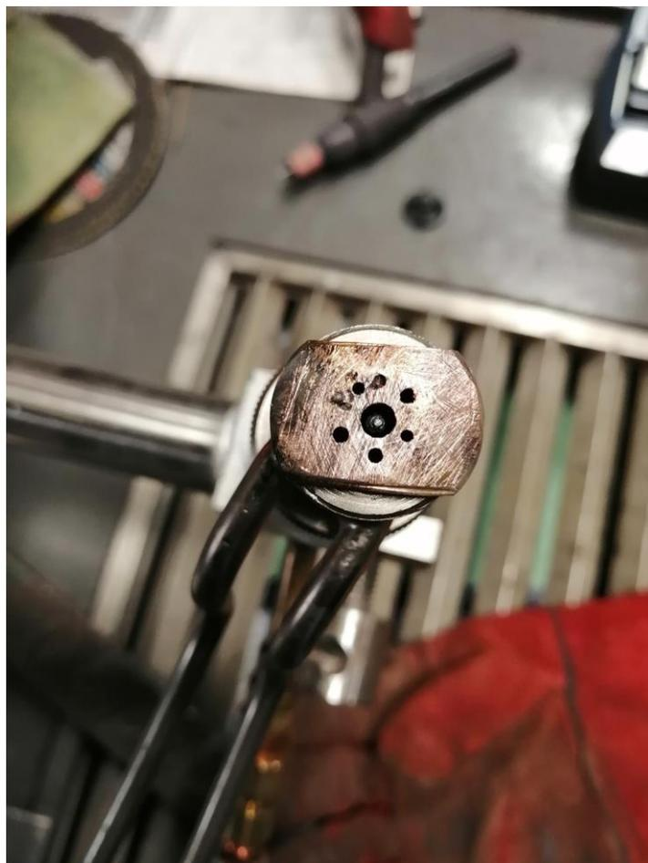
Рисунок 27– Внешний вид плазмотрона ПТРС-1 с торца
