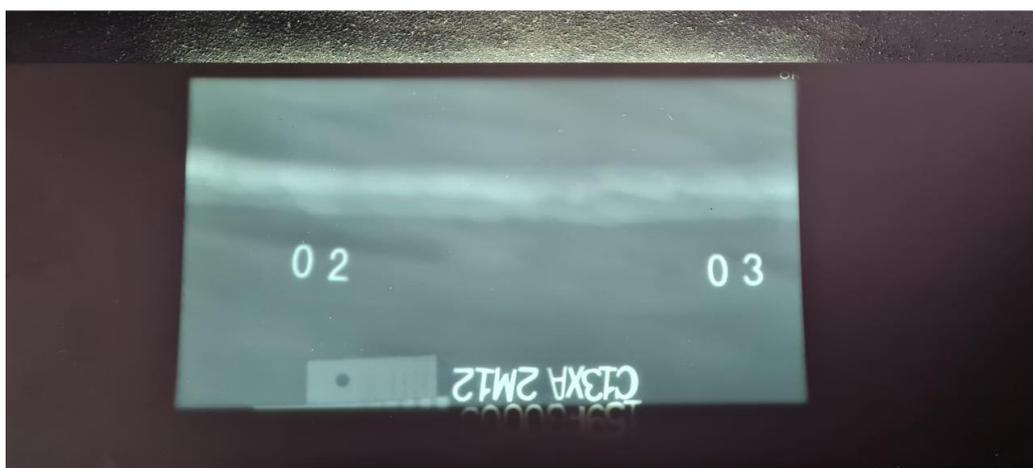
Рисунок 22. Снимок рентгенографического контроля - 4 образец
