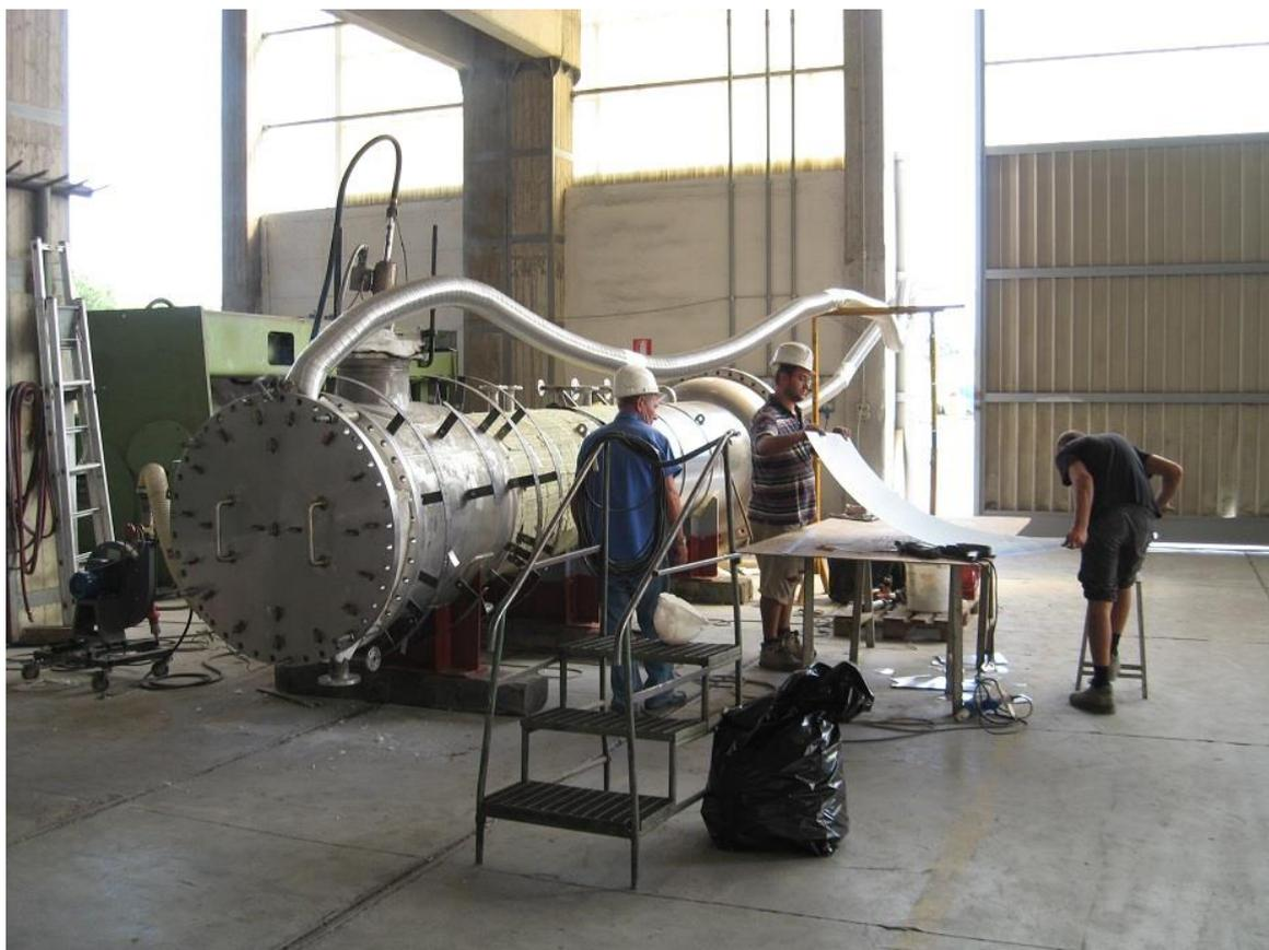
Рисунок 1. Теплообменник печи дожига хвостовых сероводородсодержащих и нефtezависимых газов
