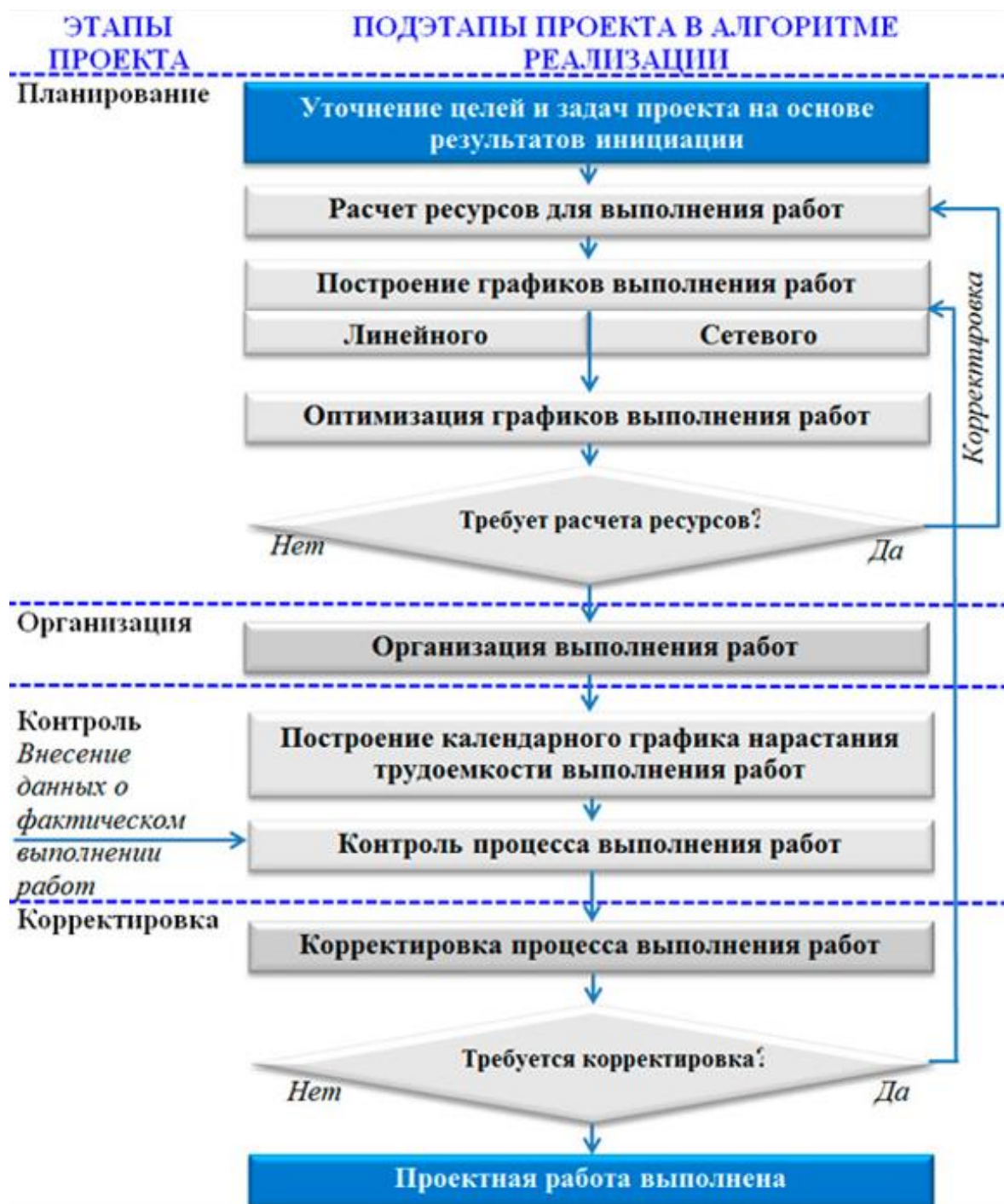
Рисунок 8 - Блок-схема управления проектом
