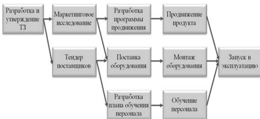
Рисунок 5 - Модель сетевого графика по методу «вершина - работа»
