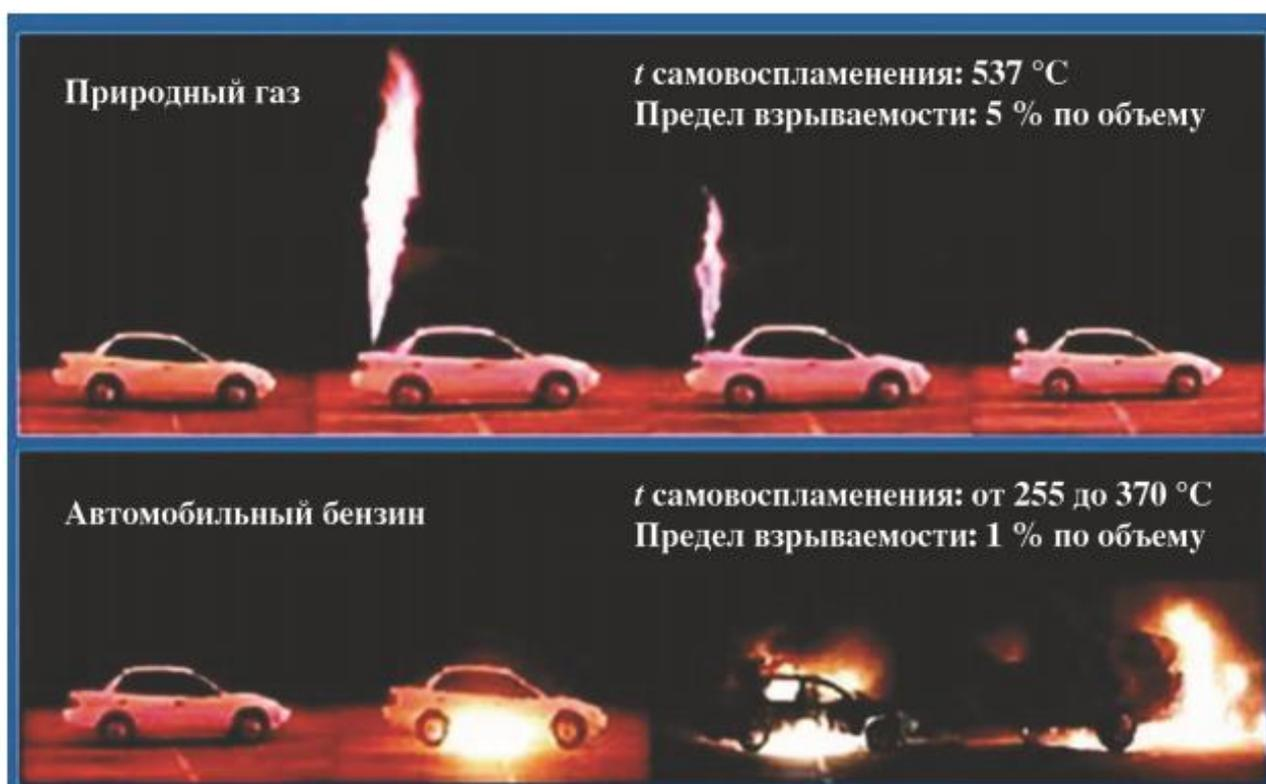
Рисунок 1.3 – Схема возгорания топлива в автомобиле
