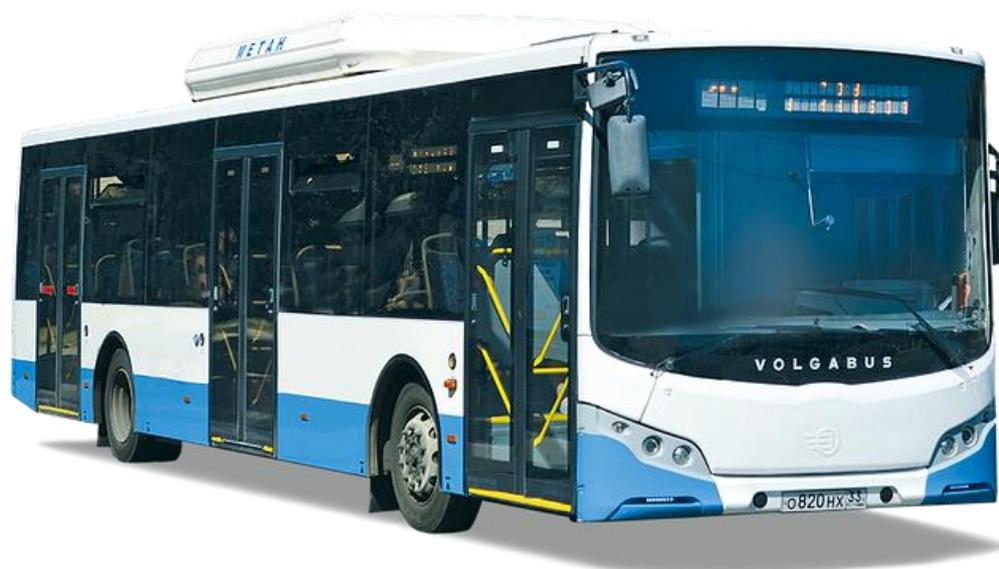
Рисунок 1.8 – Волгобас 5270G2, работающий на компримированном природном газе
