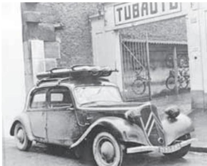
Рисунок 1.2 – Легковой автомобиль марки Citroens газовой аппаратурой
