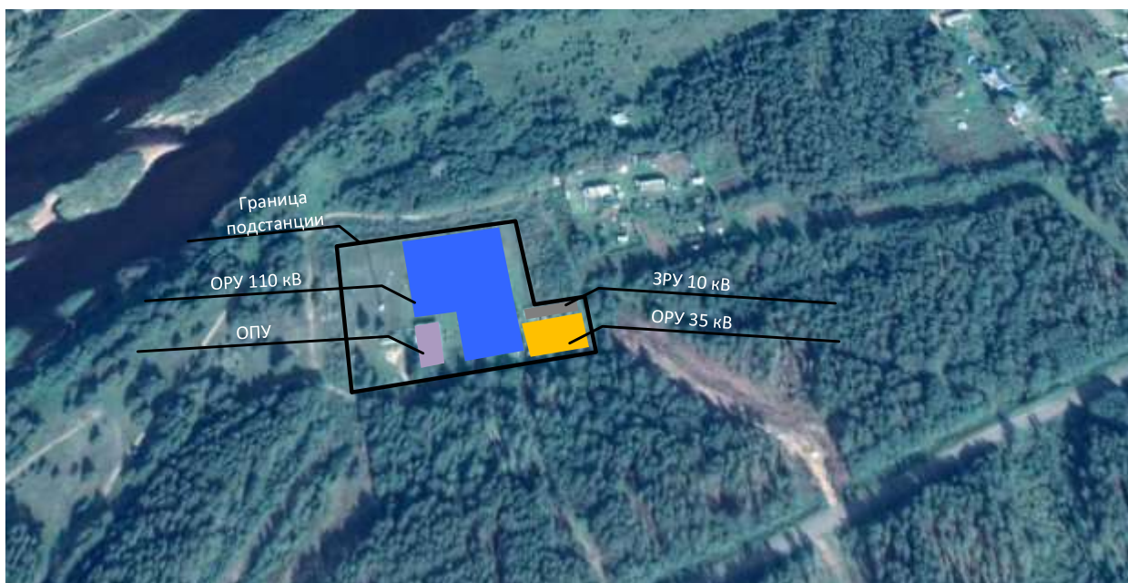
Рисунок 2 - Компоновка подстанции "Устюжна"
