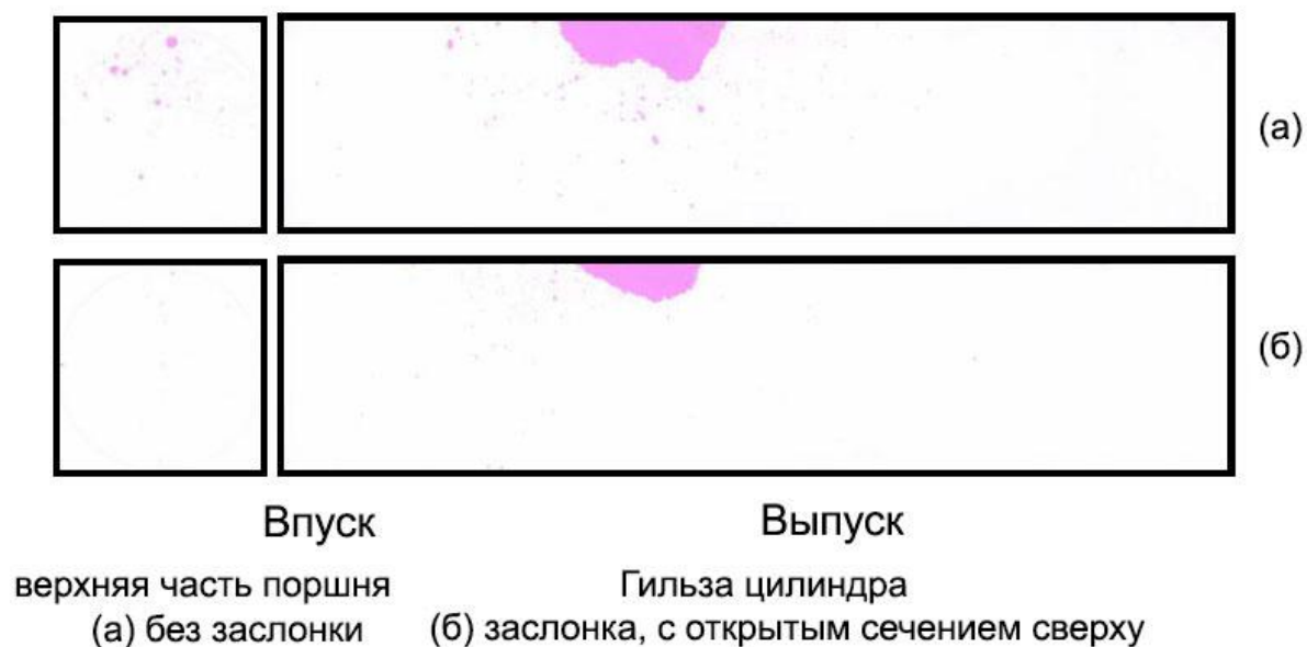
Рисунок 1.33 - Смоченные отпечатки на верхней части поршня и гильзе цилиндра при закрытом впускном клапане.
