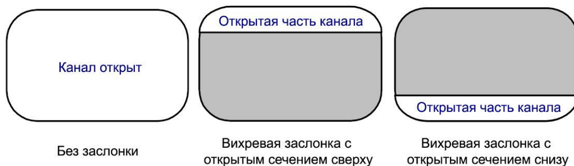
Рисунок 1.31 - Заслонки, генерирующие вихрь tumble
