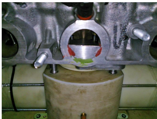
Рисунок 3.6 –ГБЦ ВАЗ-21126 с ширмой, закрывающей нижнюю половину канала
