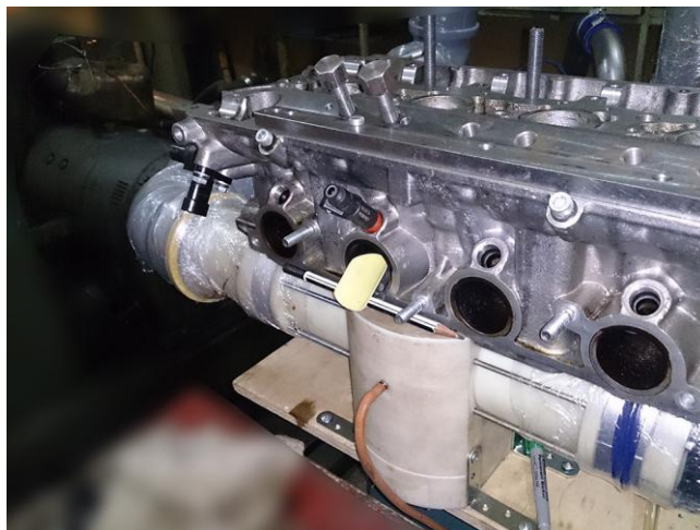
Рисунок 3.1 – Внешний вид ГБЦ ВАЗ-21126 с установленной на нее заслонкой
