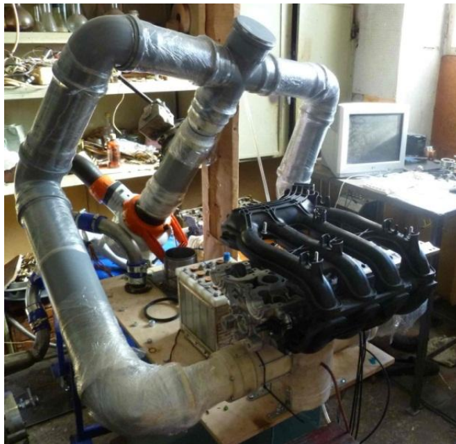
Рисунок 2.3 – Внешний вид стенда продувок ГБЦ
