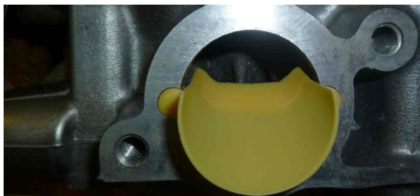
Рисунок 3.12 – Сопло, установленное во впускном канале ГБЦ ВАЗ-21126
