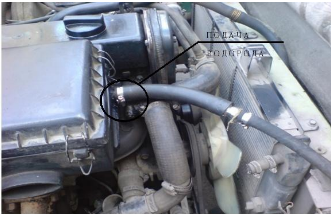
Рисунок 2.3 – Место подачи водорода во впускной коллектор двигателя
