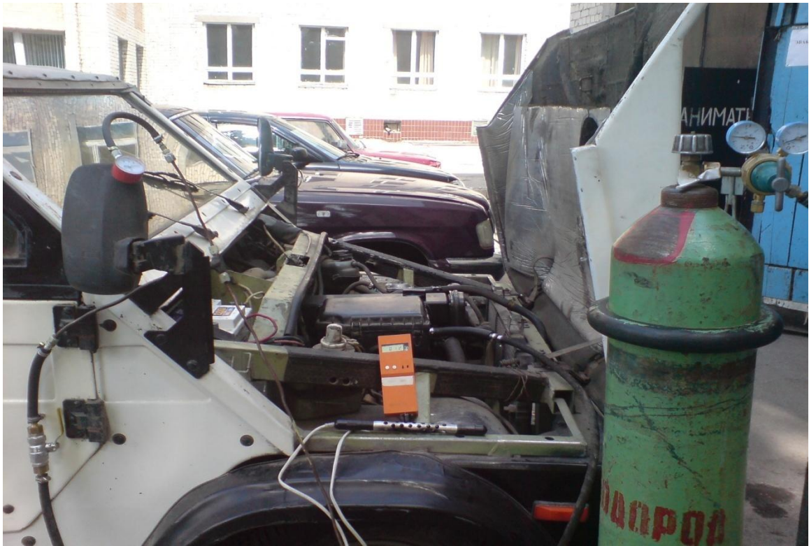
Рисунок 2.2. – Общий вид системы подачи водорода
