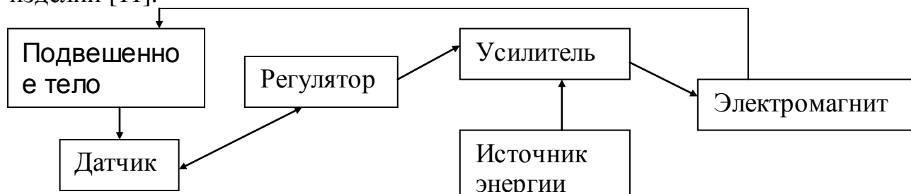
Рисунок 2.1.3 Функциональная схема активного магнитного подвеса.
