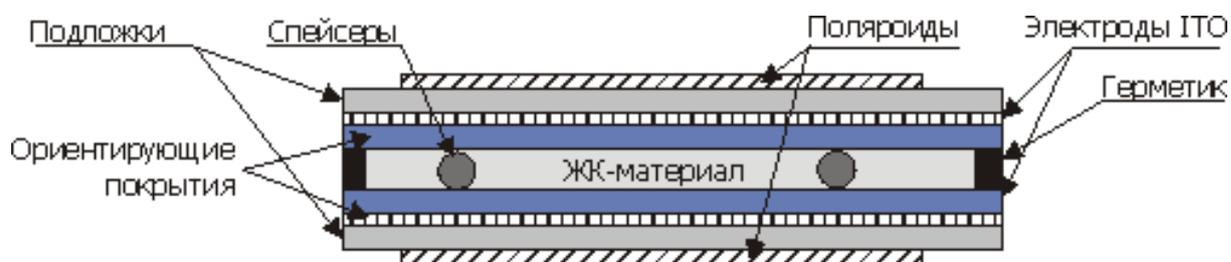
Рисунок 1.1 – Конструкция ЖК индикаторов и дисплеев.
