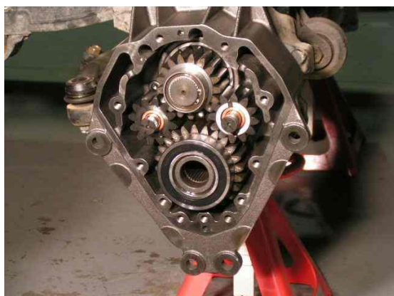
а) с шестернями наружного зацепления
