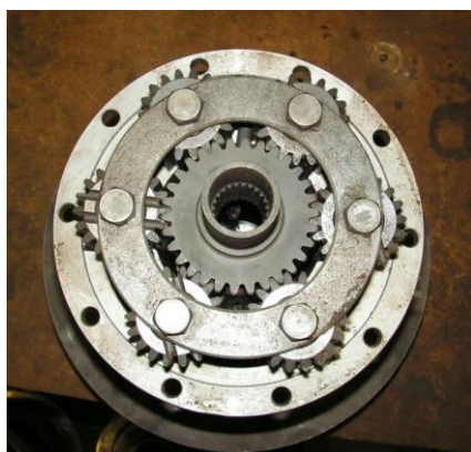
а) с шестернями наружного зацепления
