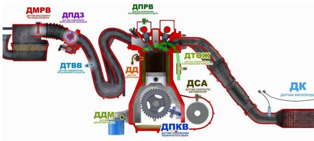
Рисунок 1 – Структурная схема микропроцессорной системы управления ДВС
