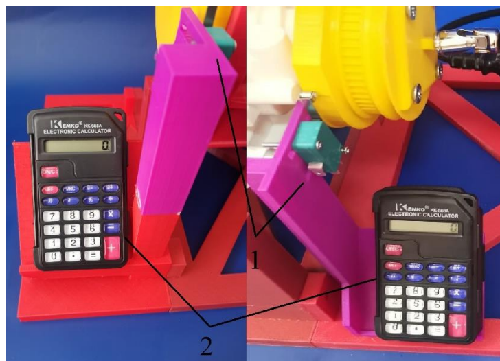
1 – концевые выключатели; 2 – считывающие устройства
