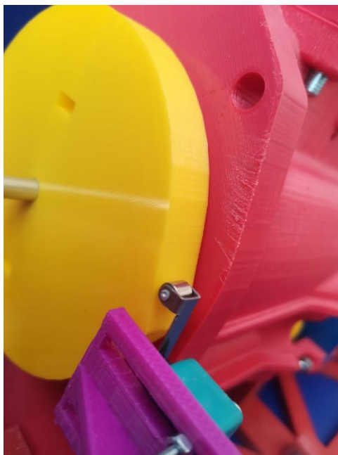
Рисунок 43 – Метка на выходном валу коробки передач при включении реверсивной передачи
