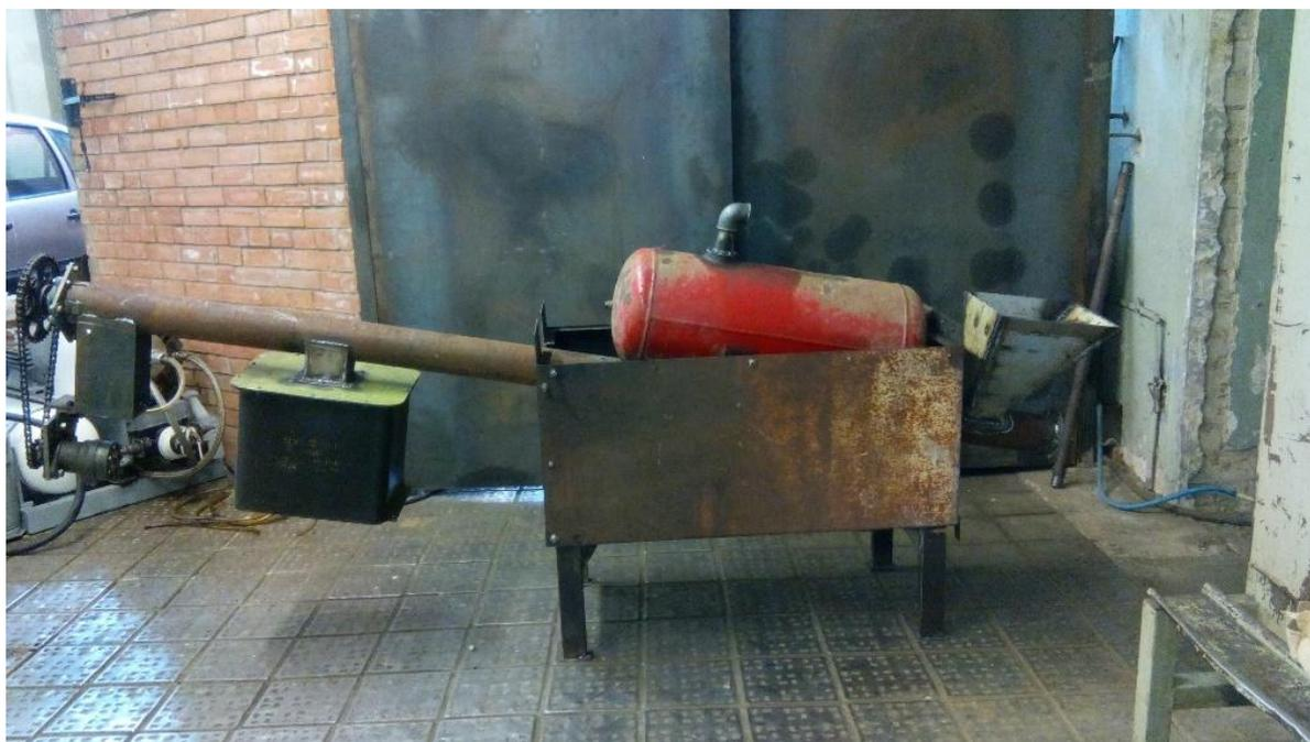
Рисунок 12 - Изготовленная пиролизная установка непрерывного действия
