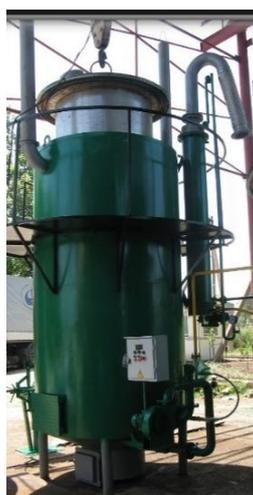
Рисунок 4 – Пиролизная установка циклического метода
