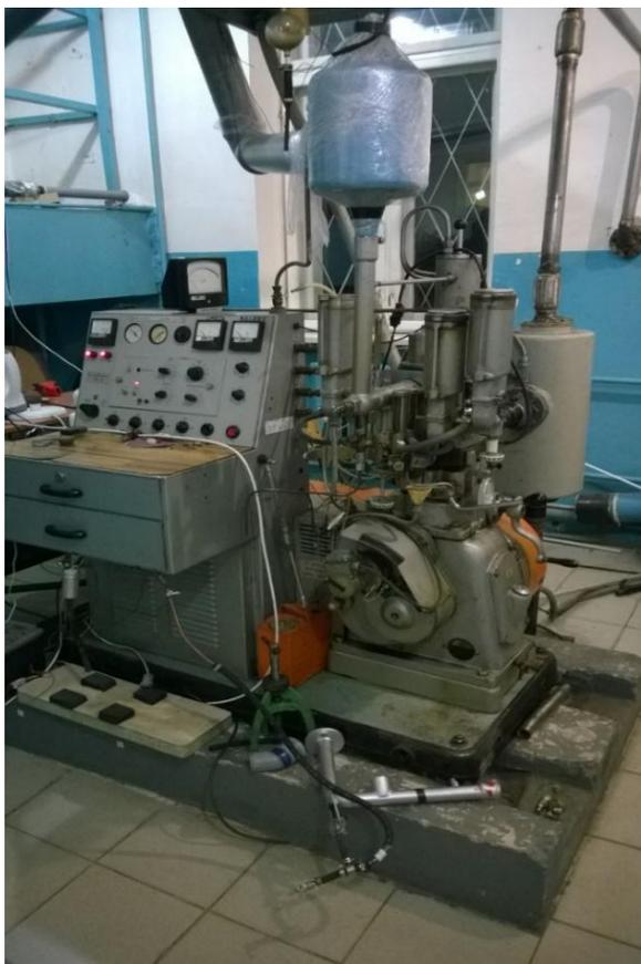
Рисунок 34 - Одноцилиндровая установка модели УИТ-85
