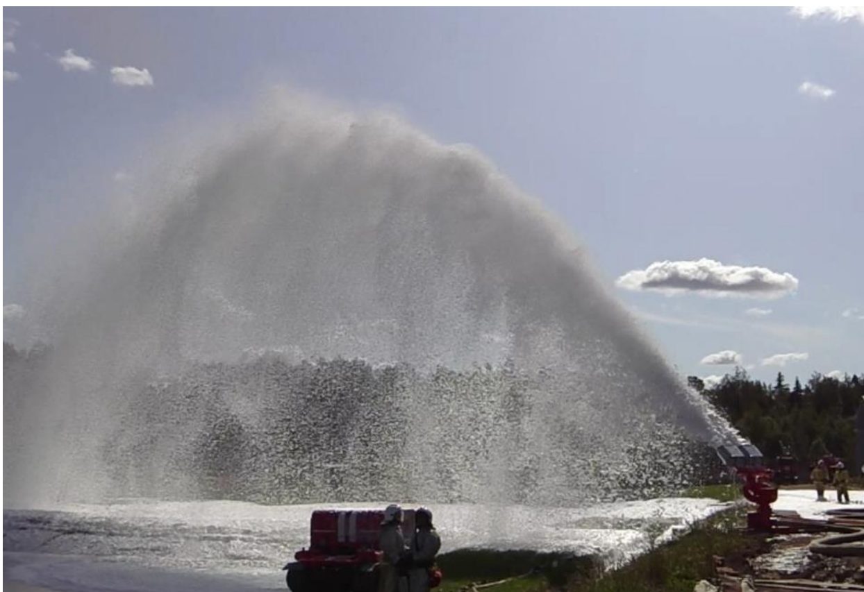
Рисунок 2 – Экспериментальные исследования подачи гибридной пены приборами генерации воздушно-механической пены
