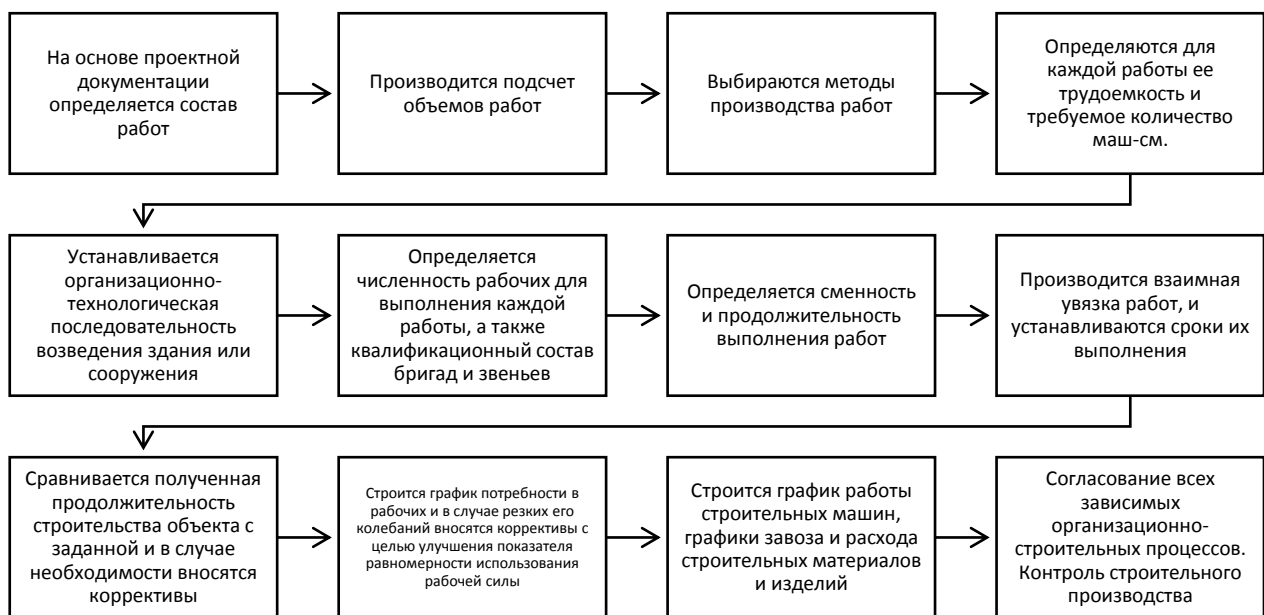
Рисунок 34 – Нормализованный порядок календарного проектирования строительного производства
