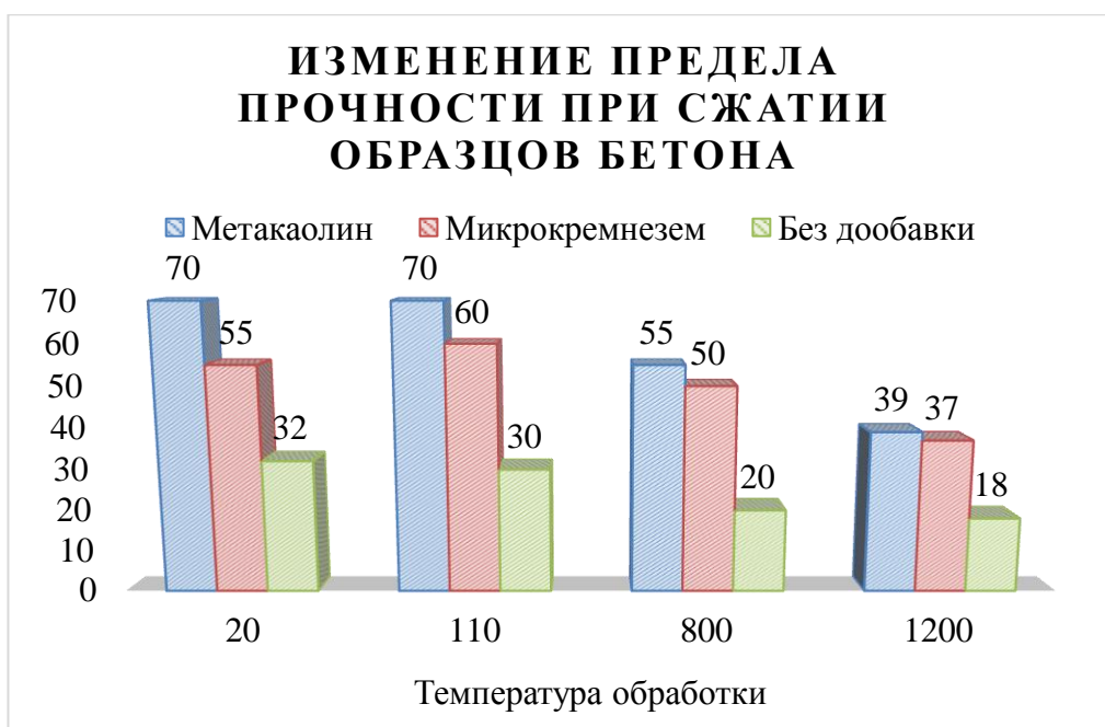
Рисунок 3.5 - Изменения предела прочности (МПа) при сжатии образцов бетона в зависимости от добавки и температуры обработки.
