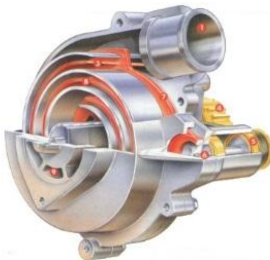
Рисунок 1.3 – Спиральный компрессор G-lader от VW
