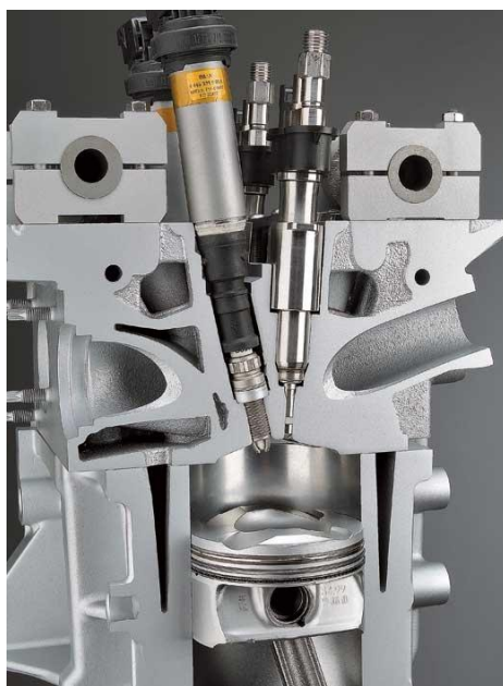
Рисунок 4.3 – Разрез двигателя BMW (HPi)
