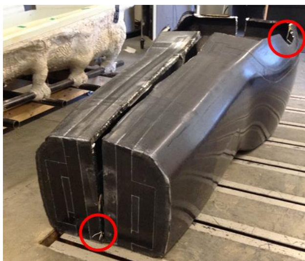
Рисунок 23 – Пример места расположения термопар на монококе
