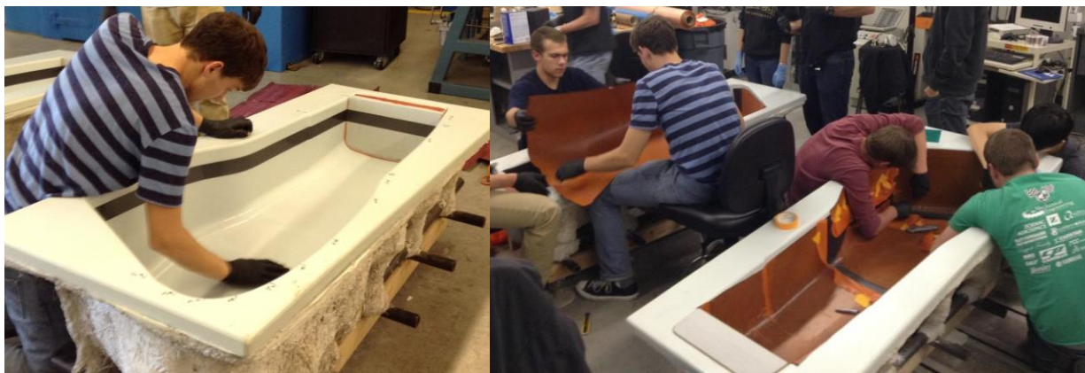
Рисунок 22 – Пример оснастки для монокока
