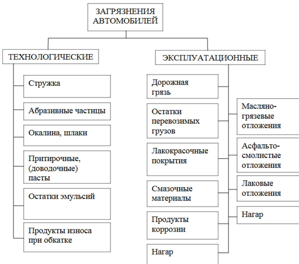
Рисунок 1 – Классификация загрязнений автомобиля
