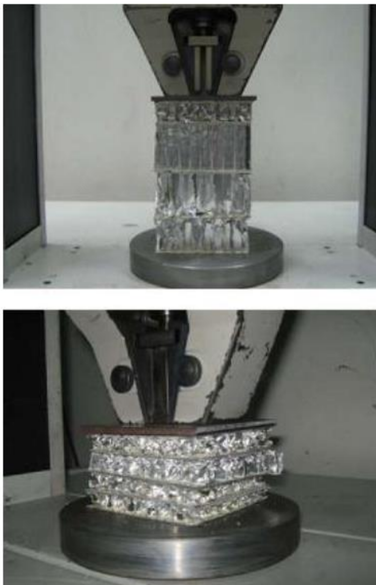
Рисунок 11 – Испытания сотового материала
