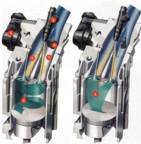
Рисунок 10 – Система впуска переменного сечения
