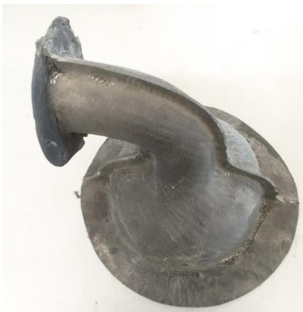
Рисунок 20 – Промежуточный вариант корпуса ресивера
