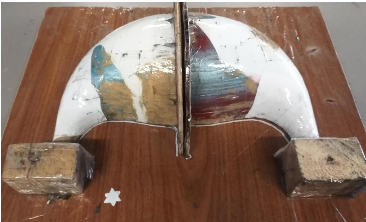
Рисунок 19 – Матрица части ресивера
