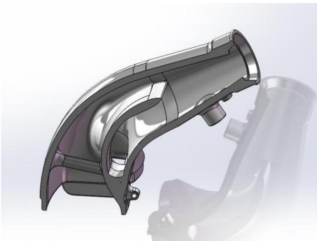
Рисунок 14 – Внутренне сечение ресивера с двойным объемом
