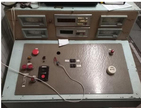
Рисунок 30 – Станция управления для нагрузочного стенда SCHENCK U1-16h
