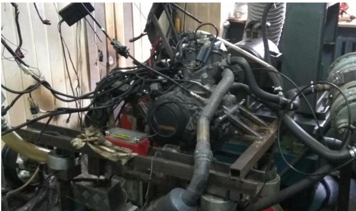
Рисунок 24 – Предыдущая оснастка для размещения ДВС на стенде
