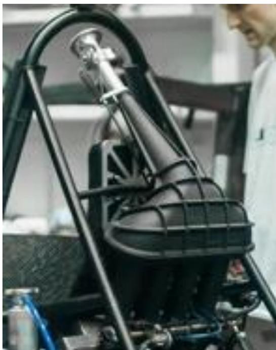
Рисунок 6 – Ресивер с банкой изготовленный на 3D принтере
