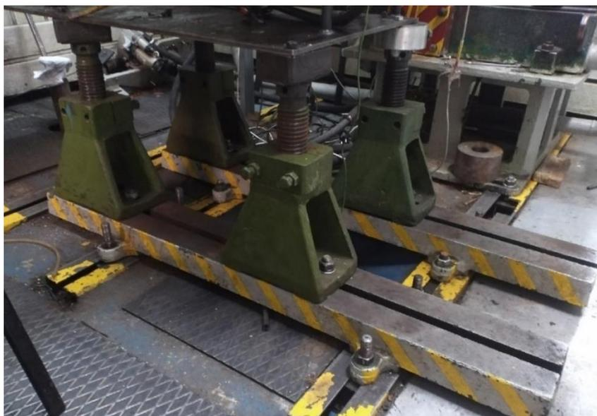
Рисунок 28 – Опоры для двигателя с подрамником
