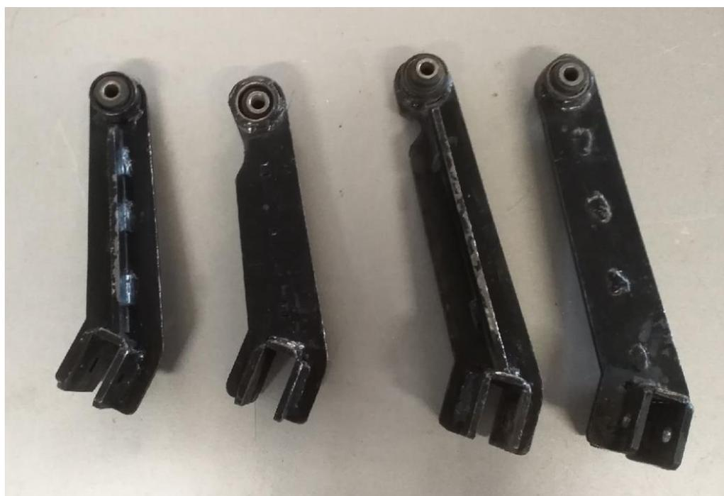
Рисунок 26 – Опоры для крепления двигателя на оснастке для нагрузочного стенда
