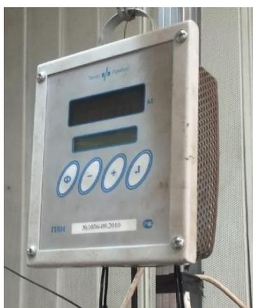
Рисунок 31 – Устройство для отображения крутящего момента на стенде
