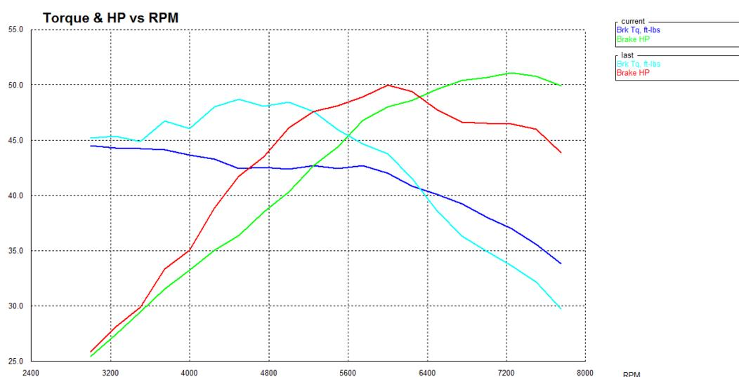
Рисунок 40 – Сравнение впускных систем с длиной раннера 100 мм и 250 мм
