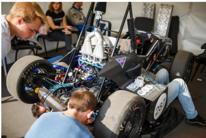
Рисунок 9 – Ресивер изготовленный из алюминия
