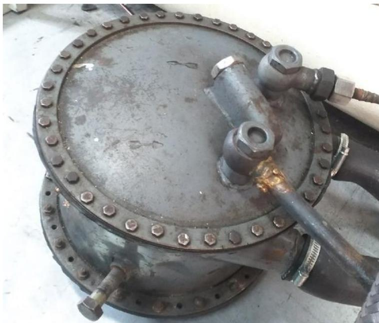
Рисунок 29 – Теплообменник используемый во время настройки ДВС
