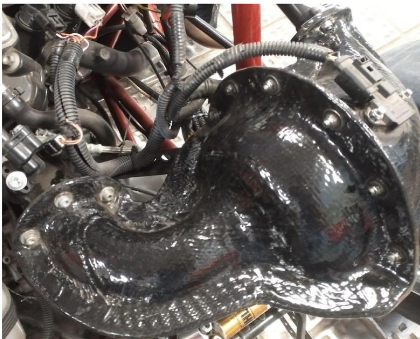
Рисунок 22 – Рабочее состояние ресивера
