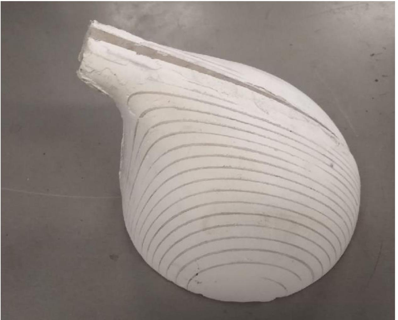
Рисунок 21 – Матрица для второй части корпуса ресивера
