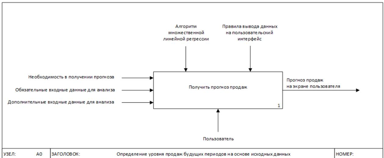
Рисунок 4 - Функциональная модель в IDEF0
