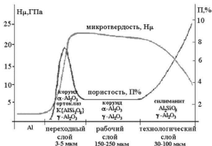
Рисунок 2.8 – Фазовый состав МДО - покрытия на алюминии
