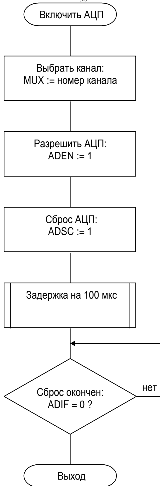
Рисунок 2.9 - Алгоритм включения АЦП на заданный канал.
