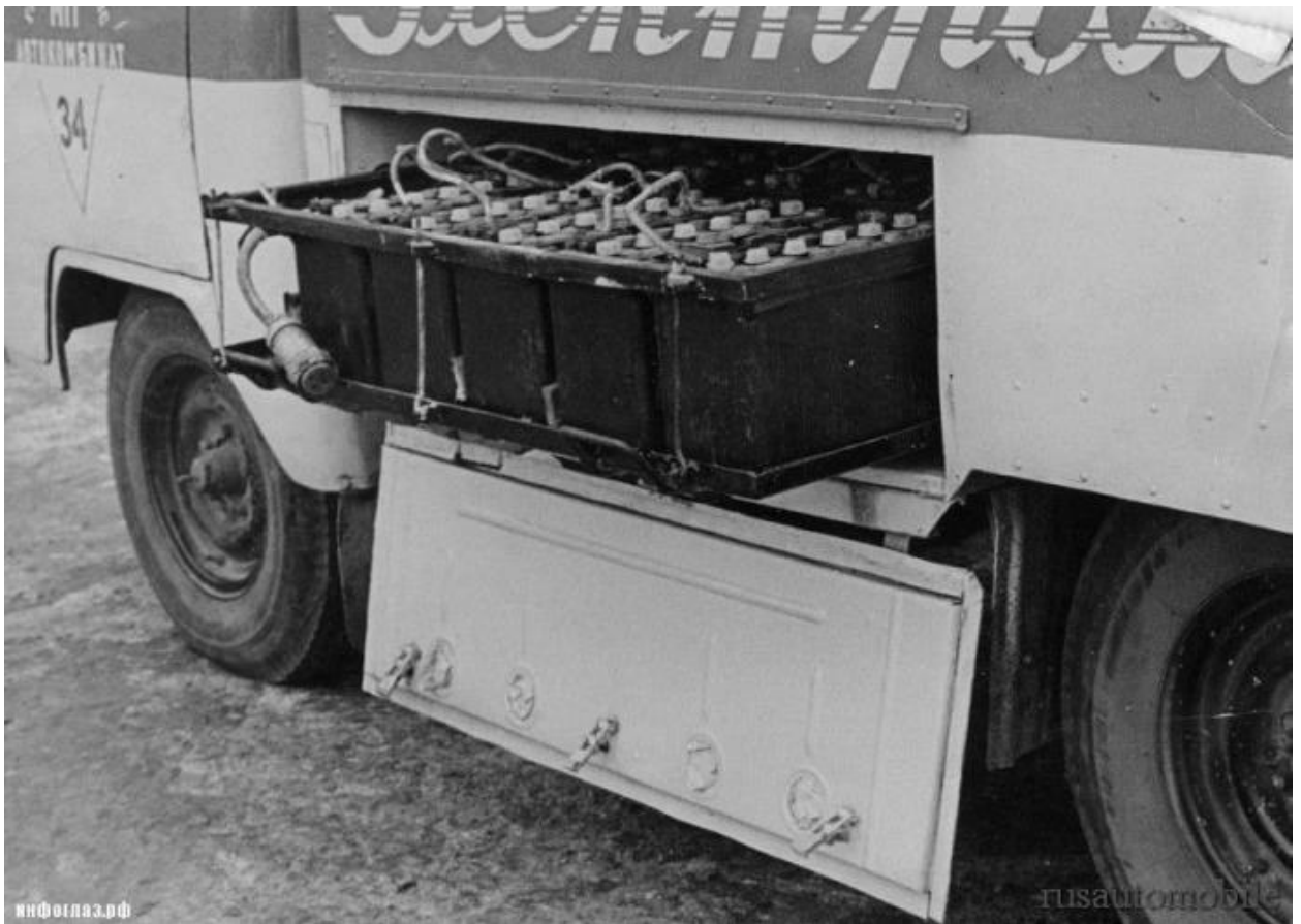
Рисунок 7 – Аккумуляторный отсек электромобиля У-131
