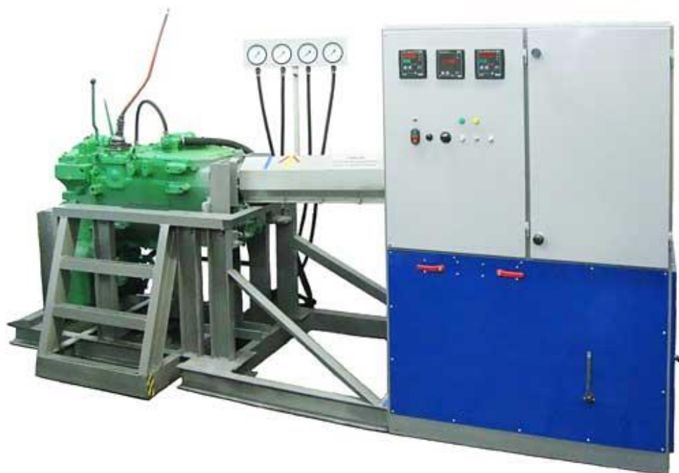
Рисунок 7 – Стенд для обкатки и диагностики автотракторных коробок передач КИ-28291
