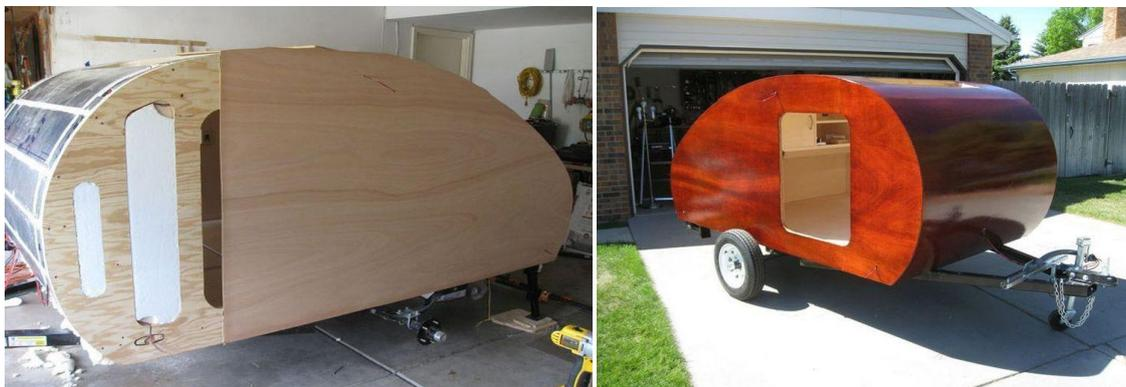
Рисунок 44 – Облицовка корпуса шпоном
