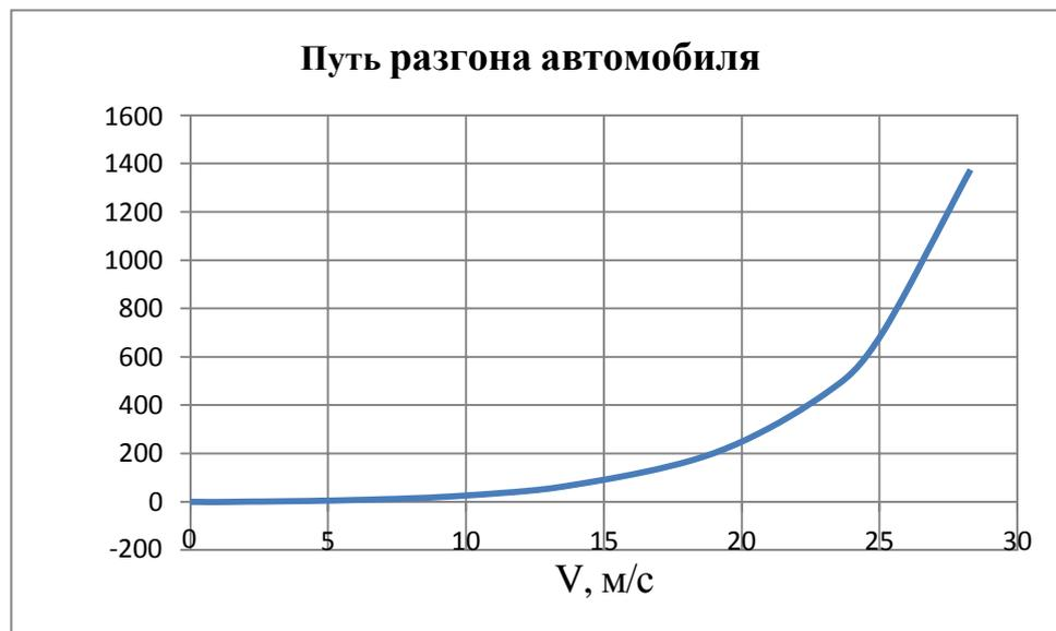
Рисунок А8 – Путь разгона автомобиля
