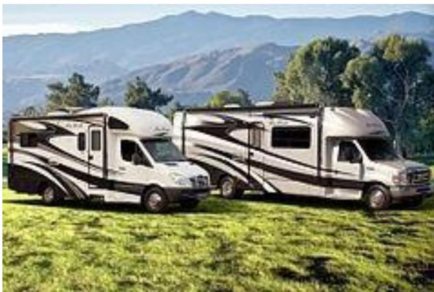
Рисунок 9 - Автодом класса С, установленный на легкий грузовик ФрейтлайнерСплинтер(слева) и шасси автомобиля Форд Е (справа)
