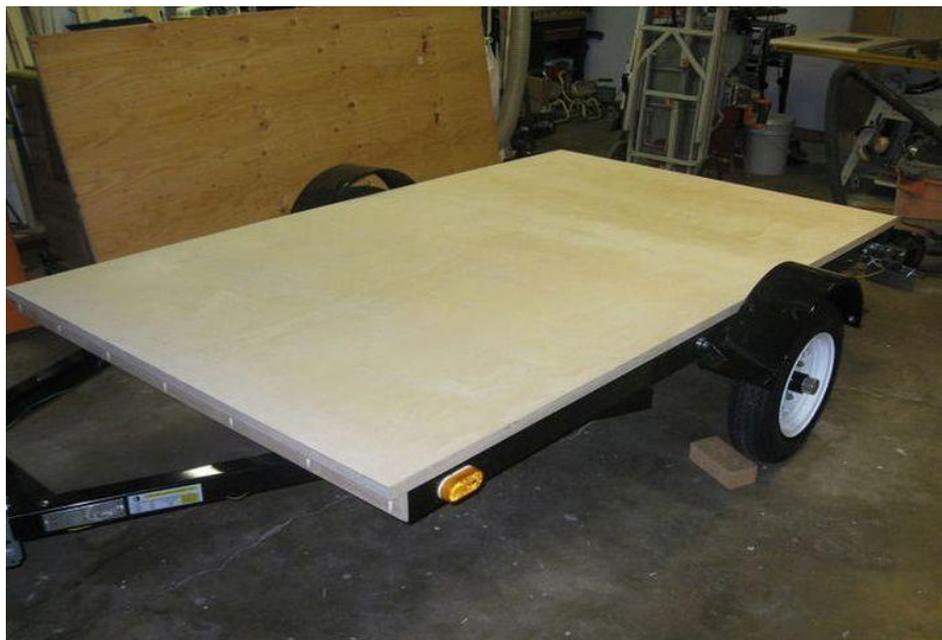
Рисунок 40 – Прицеп с закрепленным основанием
