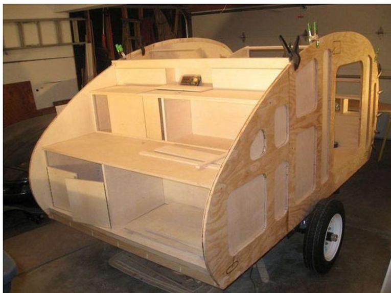
Рисунок 41 – Сборка стенок фургона
