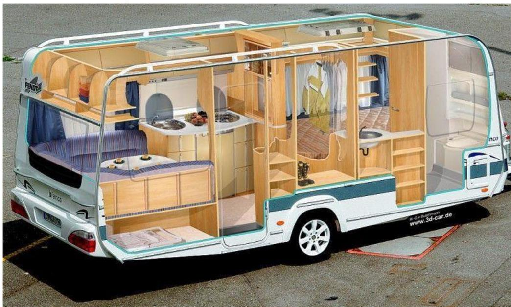
Рисунок 23 – Одноосный автодом в разрезе
