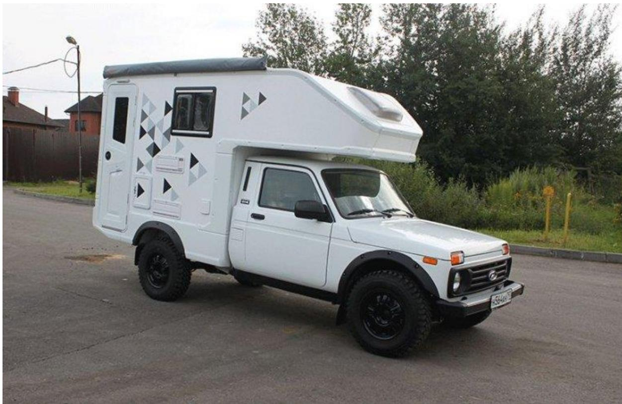
Рисунок 20 – Кемпер на базе автомобиля Лада 4x4
