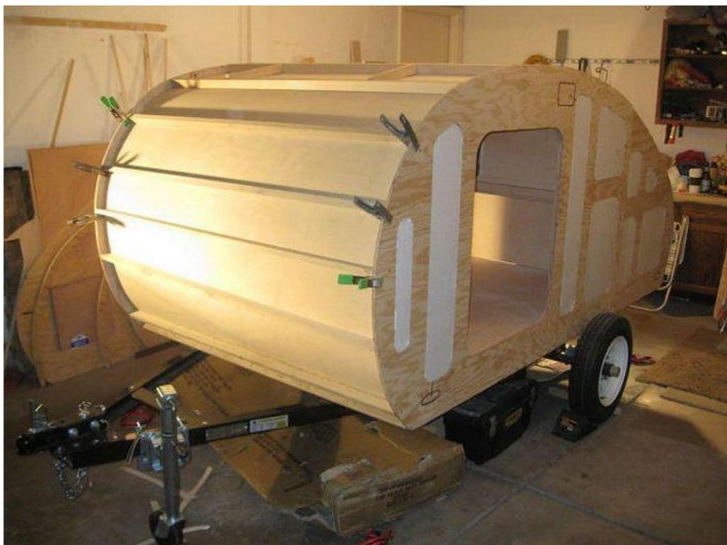
Рисунок 42 – Закрепления гнутых панелей и каркаса из бруса
