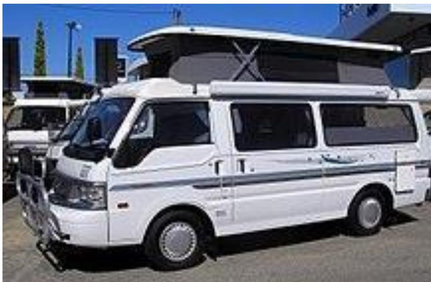
Рисунок 17 – Кэмпervан с крышей «high top» на базе микроавтобуса Мазда
