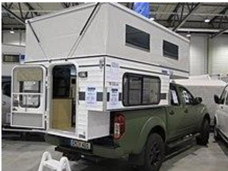
Рисунок 18 – Кэмпervан с крышей «high top» в кузове пикапа Ниссан Навара
