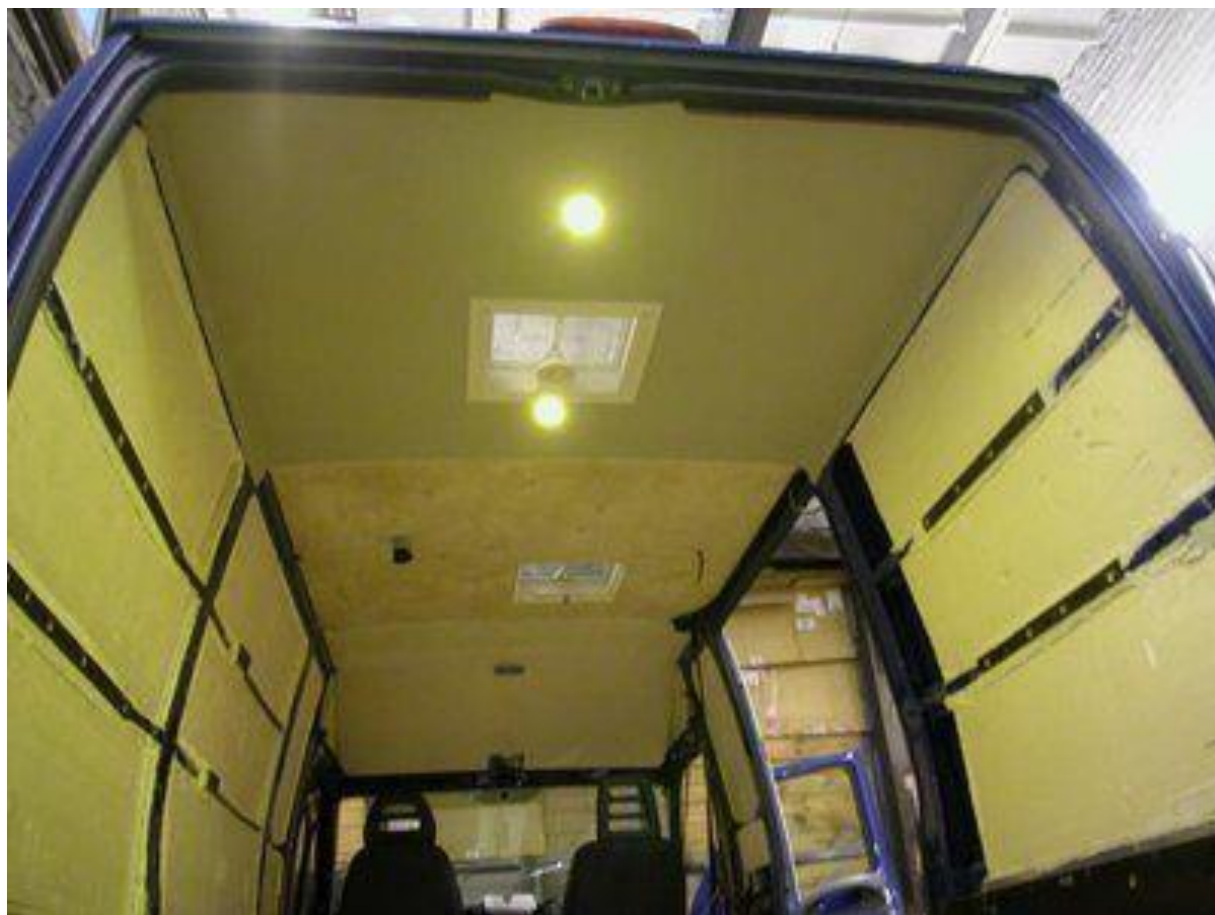
Рисунок 33 – Обшивка внутренней поверхности кузова
