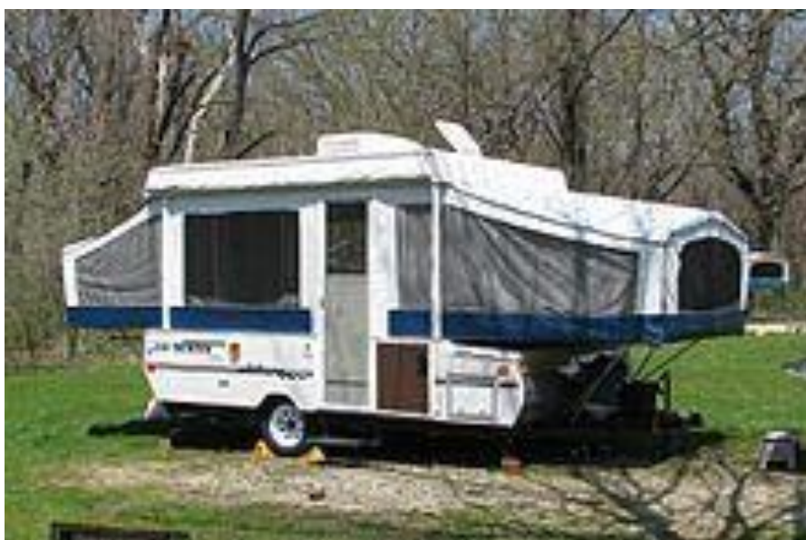
Рисунок 22 – Раздвижной кемпер в разложенном положении
