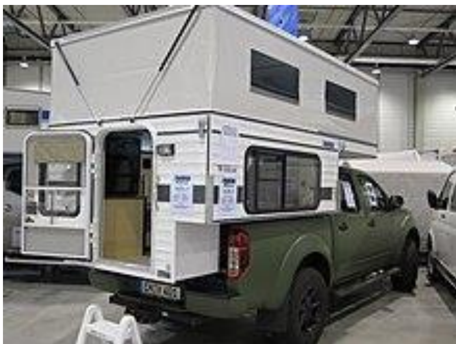
Рисунок 17 – Кэмпervан с крышей «high top» в кузове пикапа Ниссан Навара
