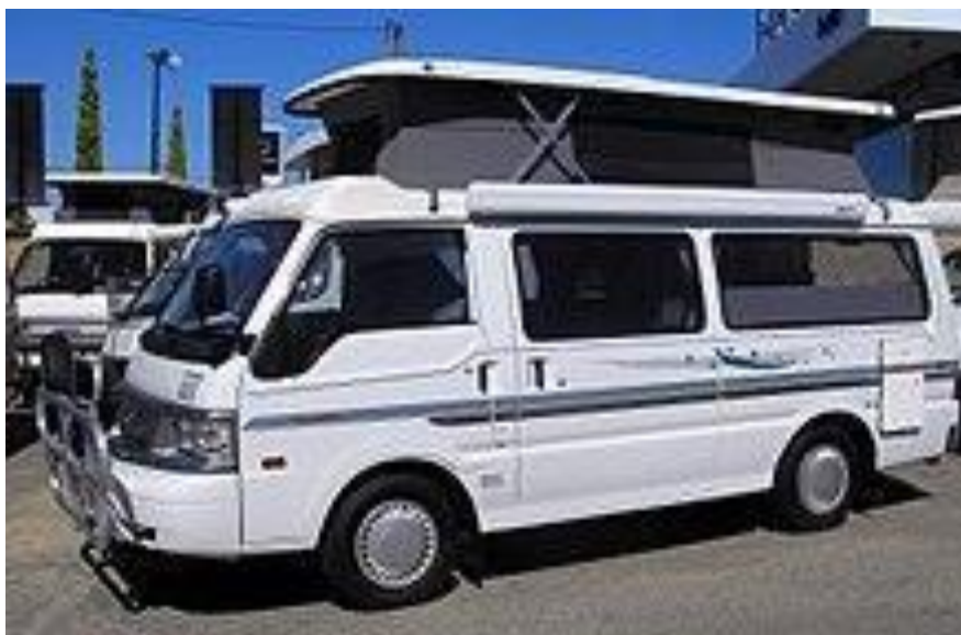
Рисунок 16 – Кэмпervан с крышей «high top» на базе микроавтобуса Mazda
