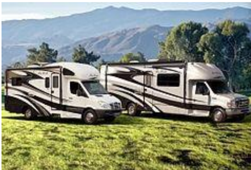
Рисунок 8 - Автодом класса С, установленный на легкий грузовик
