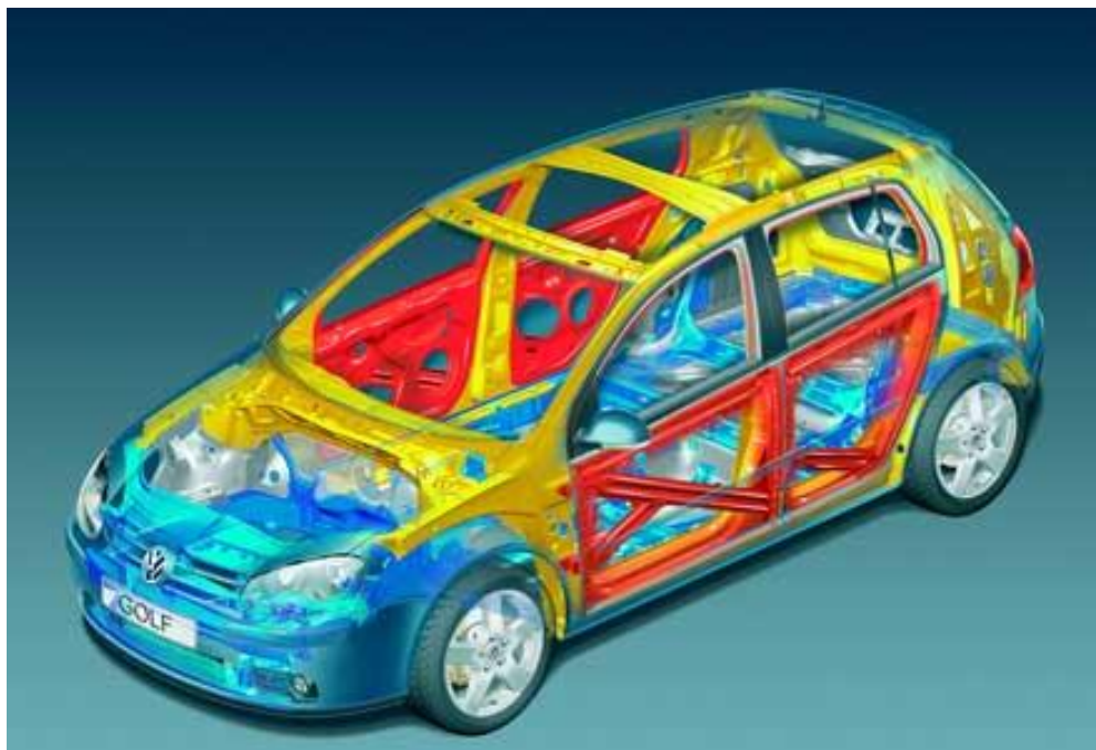
Рисунок 35 - Элементы программируемой деформации кузова
