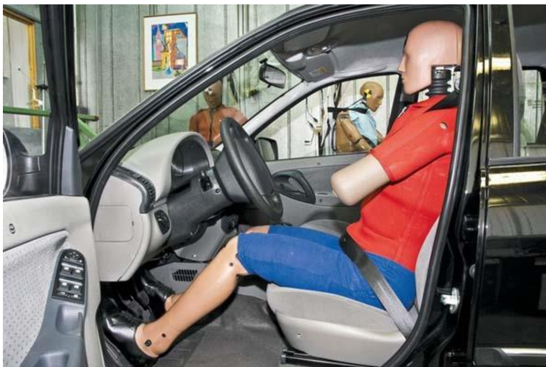
Рисунок 36 – Манекен для осуществления Краштест
