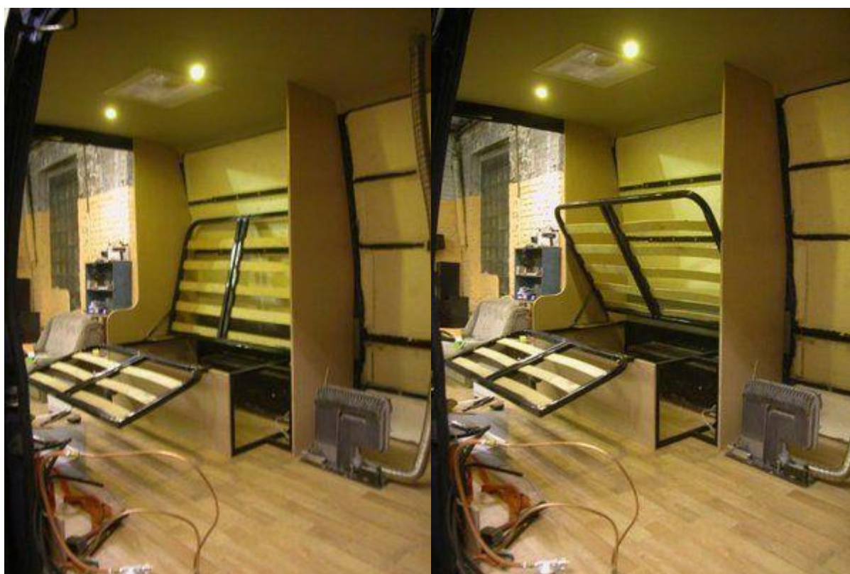
Рисунок 34 – Размещение складной кровати в кузове
