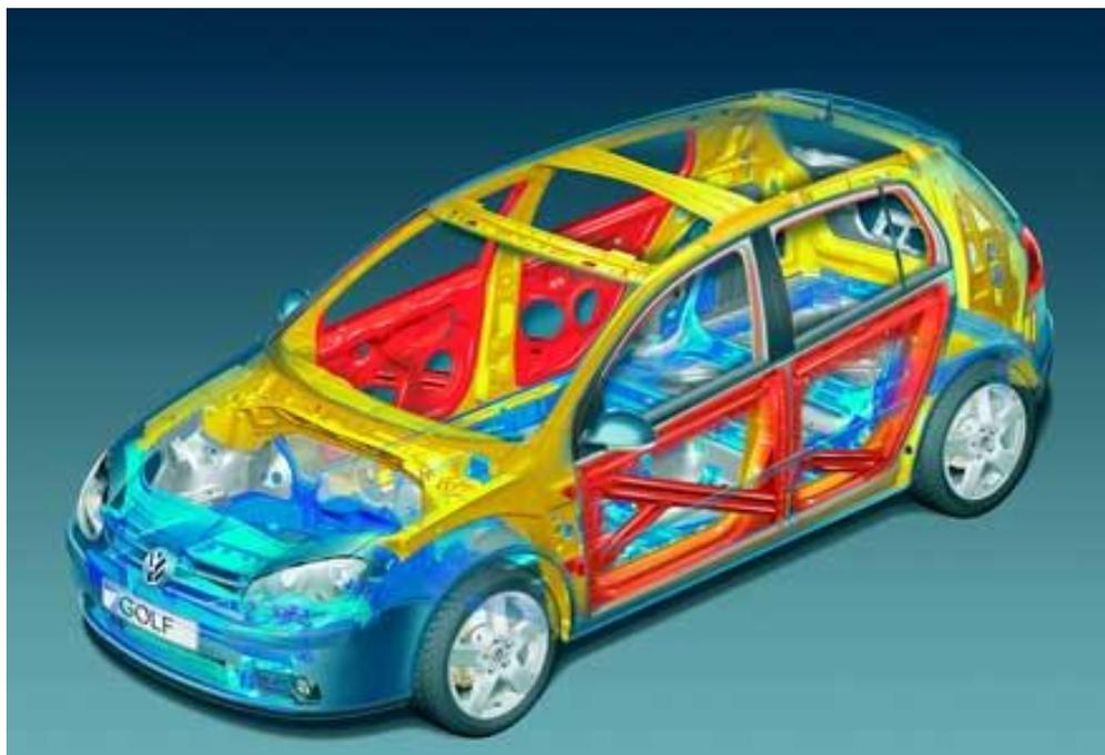
Рисунок 11 - Элементы программируемой деформации кузова
