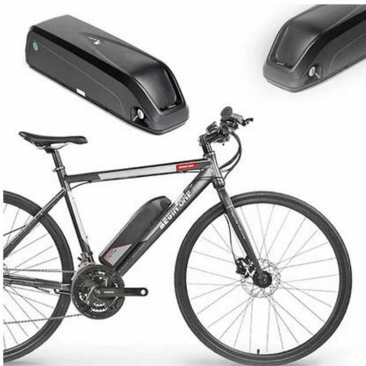
Рисунок 41 – Батарея «Дельфин» на раму
