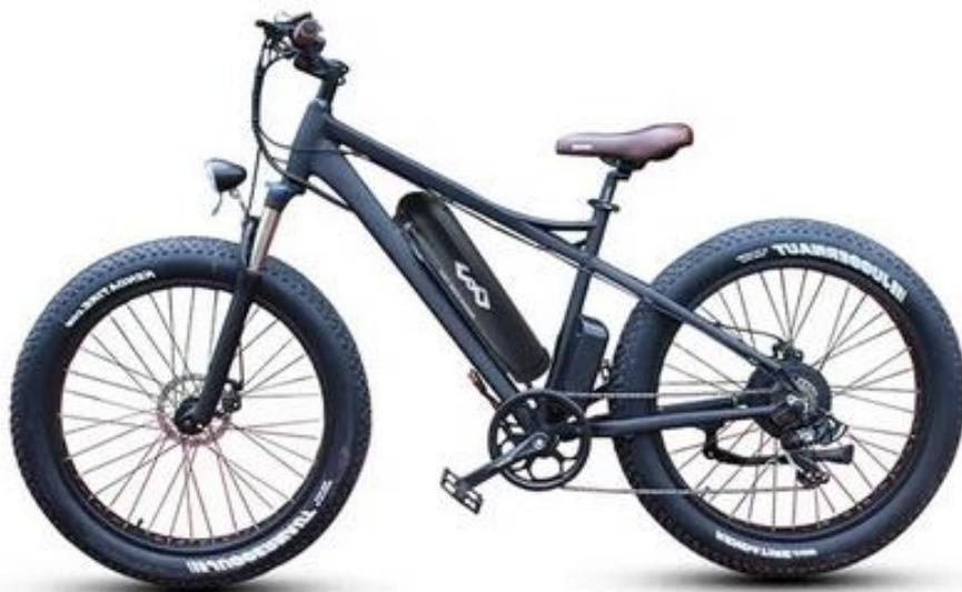
Рисунок 40 – Батарея «Бутылка» на раму
