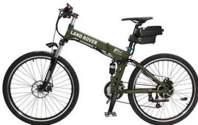
Рисунок 38 – Батарея на подседельный штырь типа «лягушка»
